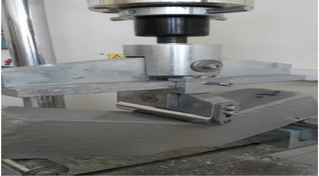
Şekil 69. Poliüre kaplamalı (4 kat ) numunelerde sehim
