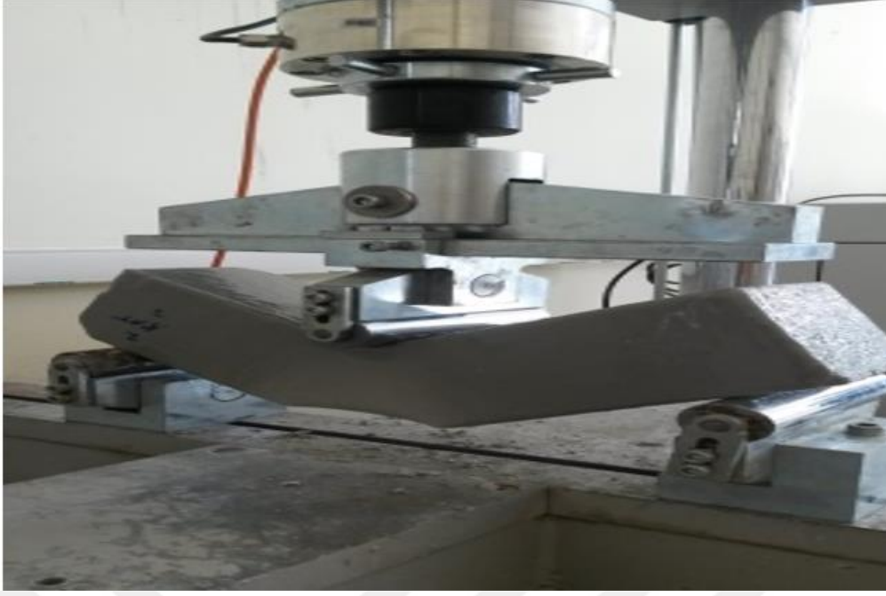
Şekil 68. Poliüre kaplamalı (2 kat) numunelerde sehim
