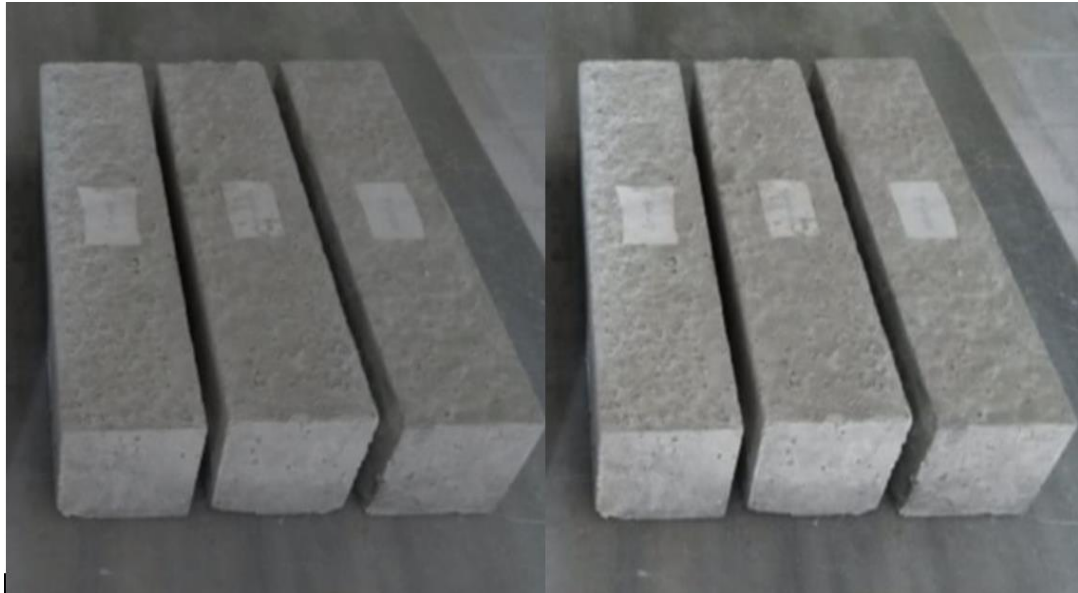
Şekil 48. Laboratuvar ortamında elde edilen 6 adet donatısız beton blok numunesi
