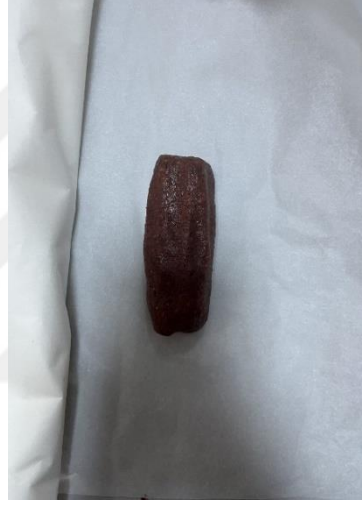
Şekil 2.24 : Hidrojenli numuneye bar şeklinin verilmesi.
