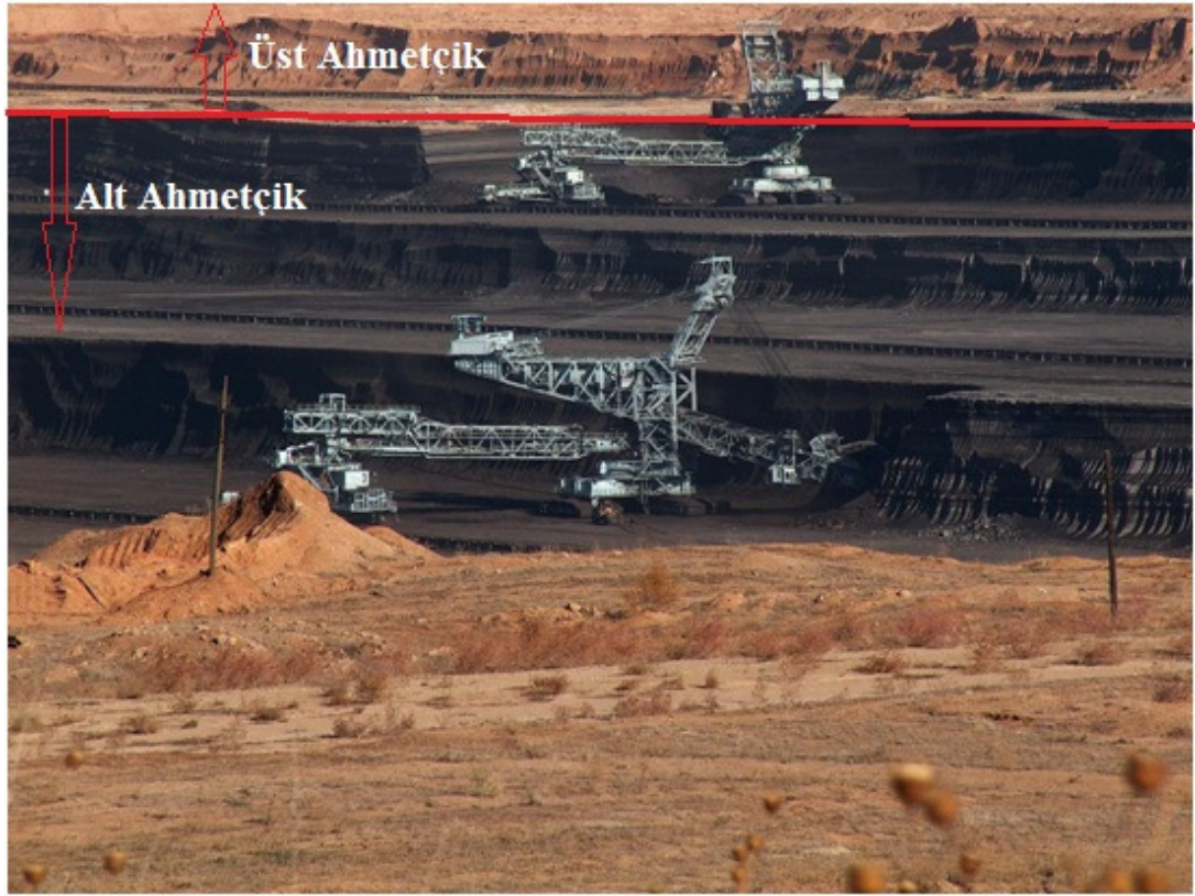
Şekil 2.3. Kömürlü alt birimli ile üst birim sınırının arazi görünümü (Afşin –Elbistan Linyit İşletmeleri kazı aynası)
