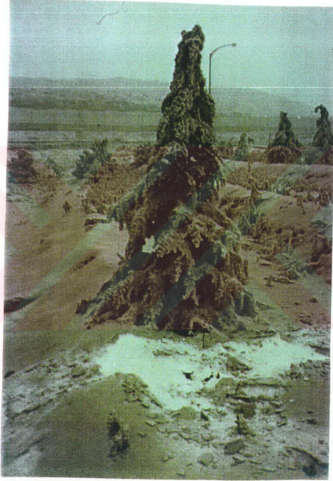
Şekil 1.2. Termik Santralin Bacasından Kaçan Uçucu Küllerin Kar Üzerinde Oluşturduğu Yığılımlar
