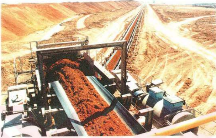
Şekil 4.8. Kazılan Her Türlü Malzemenin ve Külün Taşınmasında Kullanılan Bant Konveyörler
