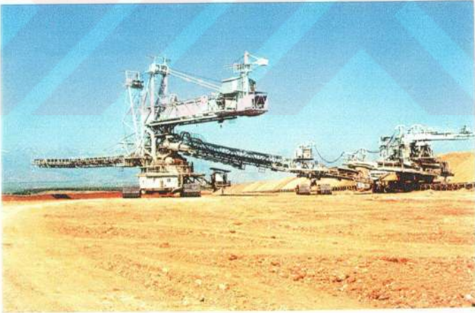
Şekil 4.7. Taşıyıcı Konveyörlerle Taşınan Malzemenin Araziye Tekrar Serilmesinde Kullanılan Dökücü İş Makinası
