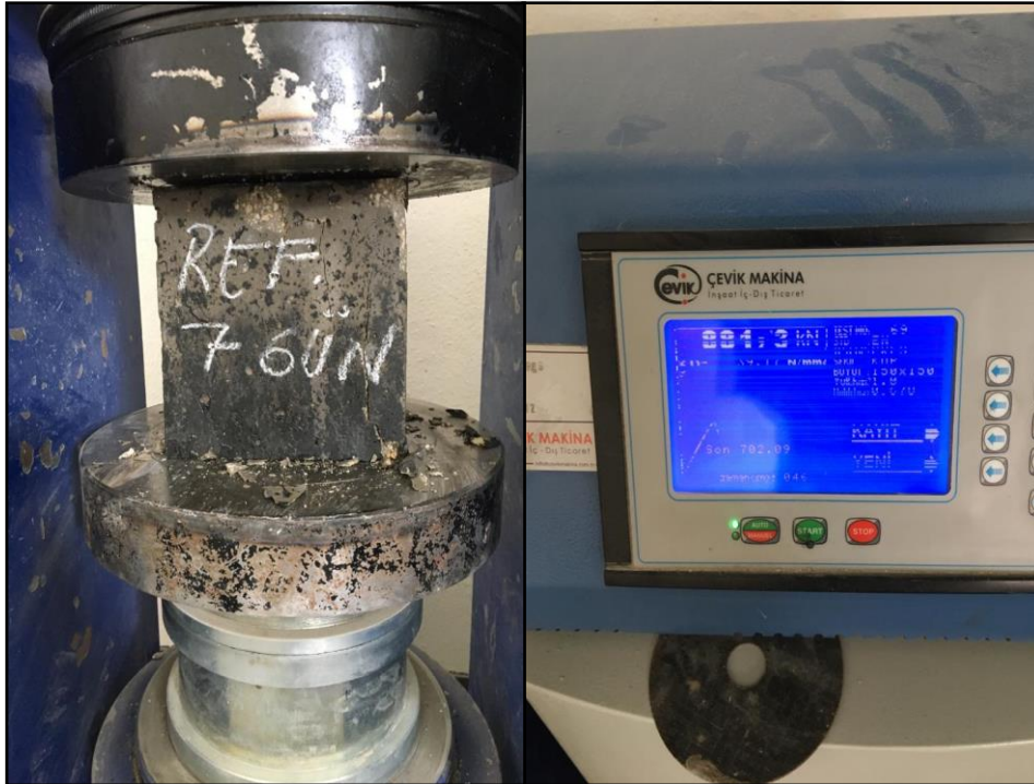
Şekil 4.16. Beton basınç deneyi yapılışı
