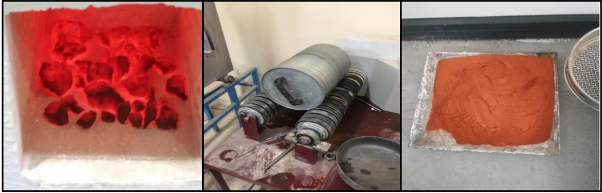
Şekil 4.8. Terra rosa malzemesinin kalsinasyon ve öğütme süreçleri
