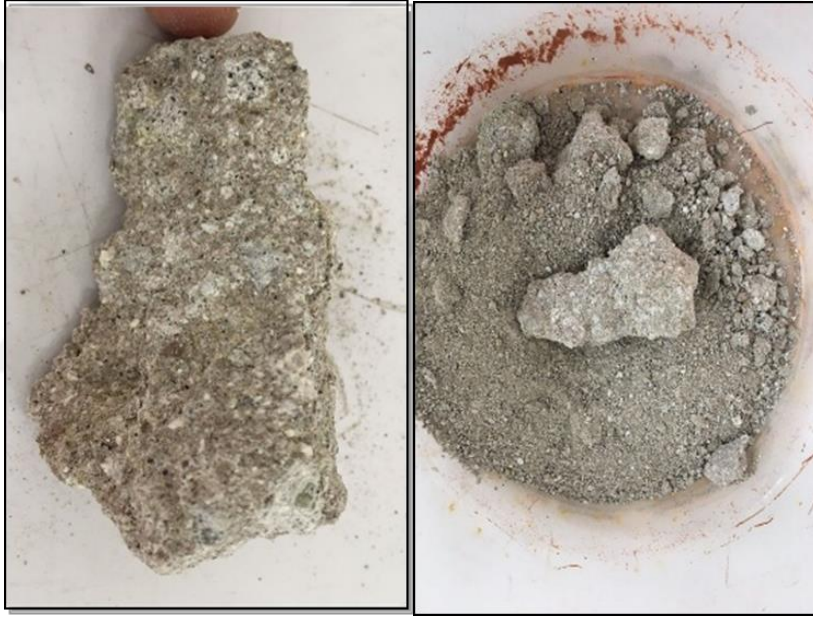
Şekil 4.3. Afyon-Gecek bölgesinden alınan tüf numunesi
