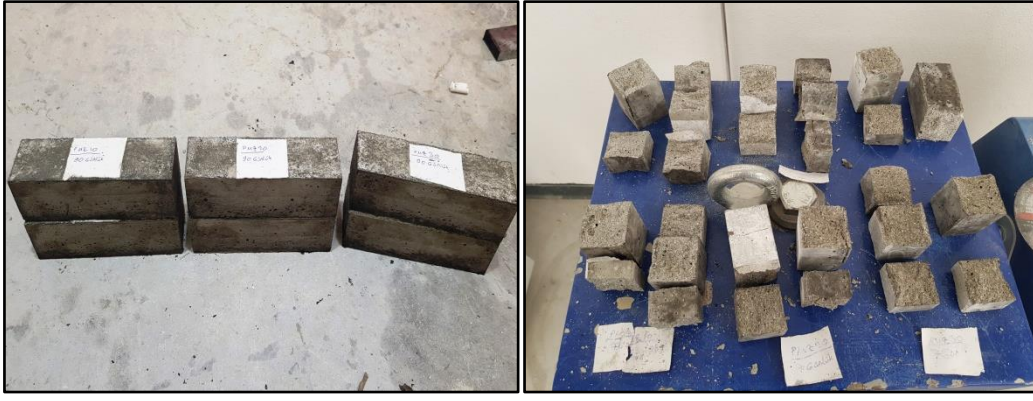
Şekil 5.7. Sertleşmiş harç numuneleri ve basınç dayanımı deneyi sonrası numuneler
