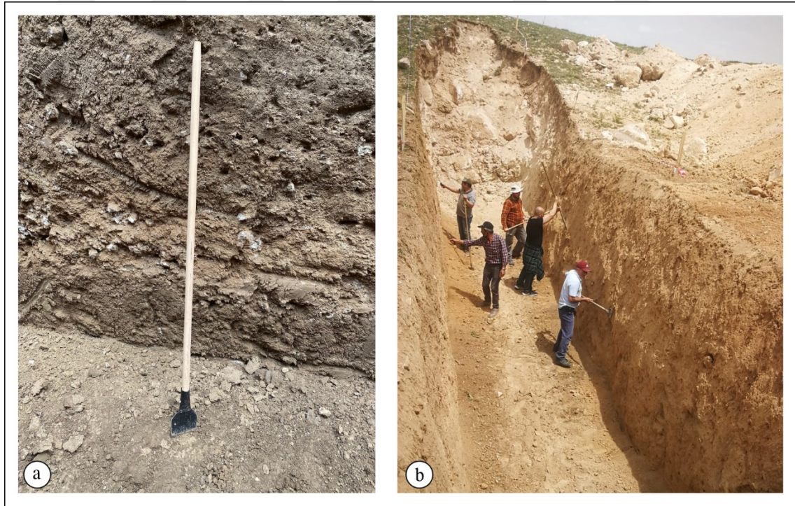
Şekil 3.3. Hendek temizlemek için kullanılan aletlerden bir tanesi (hasan-gama) (a), hendek temizleme işlemi sırasında bir görüntü (b)
