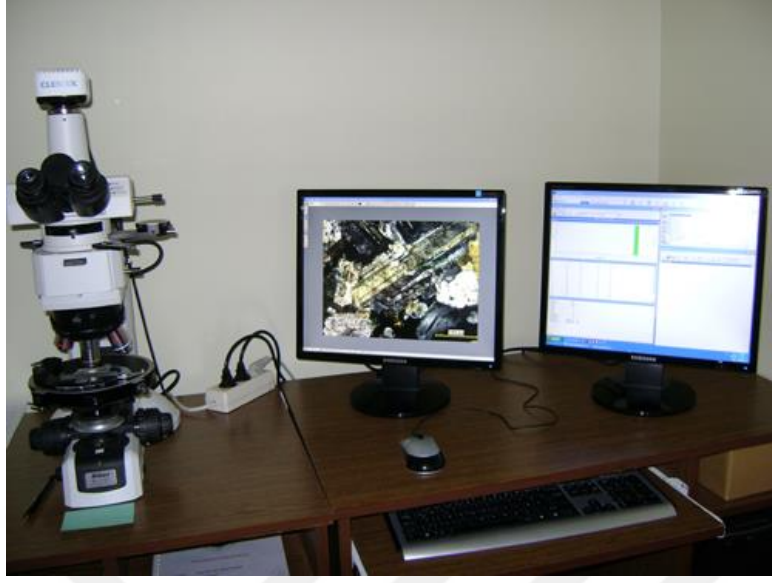
Resim 3.19 Örneklerin mineralojik ve petrografik özelliklerinin tespitinde kullanılan Nikon Eclipse 2V100POL polarizan mikroskop.
