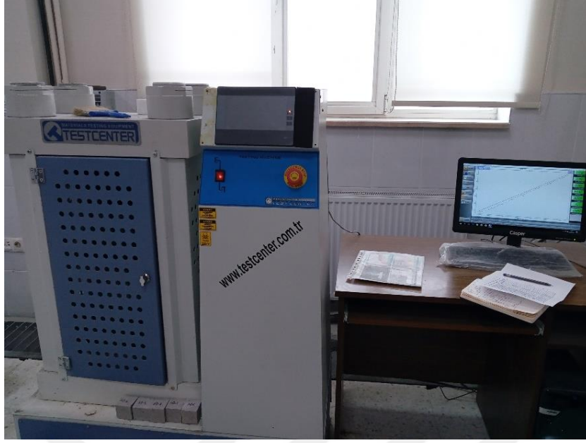
Resim 3.15 Örneklerin tek eksenli basınç deneylerinin yapıldığı cihaz.
