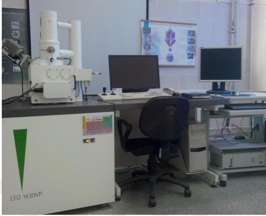
Resim 3.21 Örneklerin bileşiminde bulunan mineral ve gözenek boyutlarının incelendiği taramalı elektron mikroskopu (SEM).
