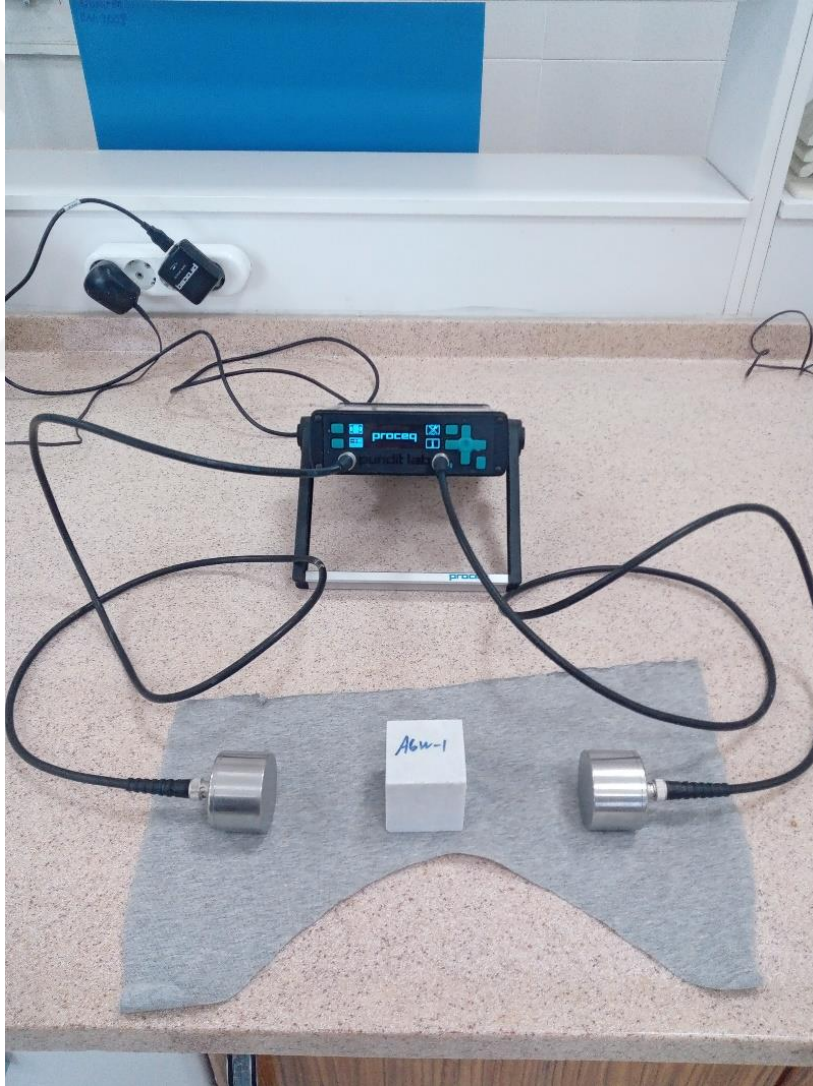
Resim 3.17 Örneklerin ultrases ses yayılma hızının tespitinde kullanılan ultrasonik test cihazı.
