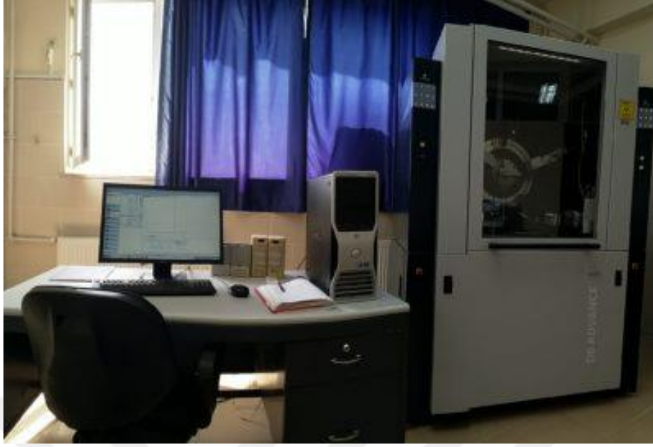
Resim 3.20 Örneklerin mineralojik özelliklerinin tespitinde kullanılan Bruker Marka D 8 Advance model X-ışınları kırınımı (XRD) cihazı.
