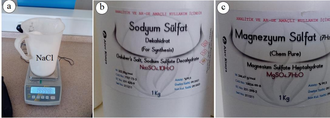
Resim 3.14 Deneylerde kullanılan tuzların görüntüleri. \text{NaCl} (a), \text{Na}_2\text{SO}_4 \cdot 10\text{H}_2\text{O} (b) ve \text{MgSO}_4 \cdot 7\text{H}_2\text{O} (c).
