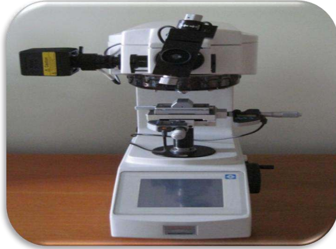
Şekil 7.4 HM-200 serisi dijital Vickers mikrosertlik cihazı.
