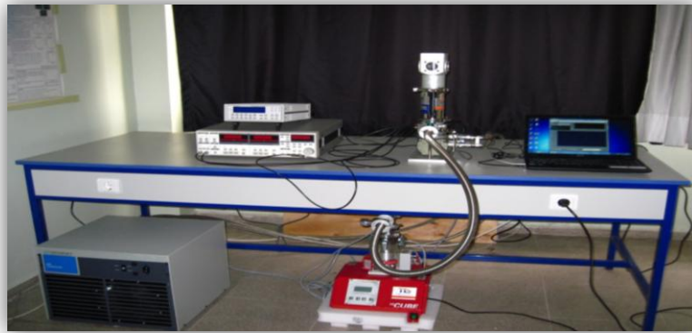
Şekil 7.3 Ac manyetik alınganlık ölçüm cihazı.
