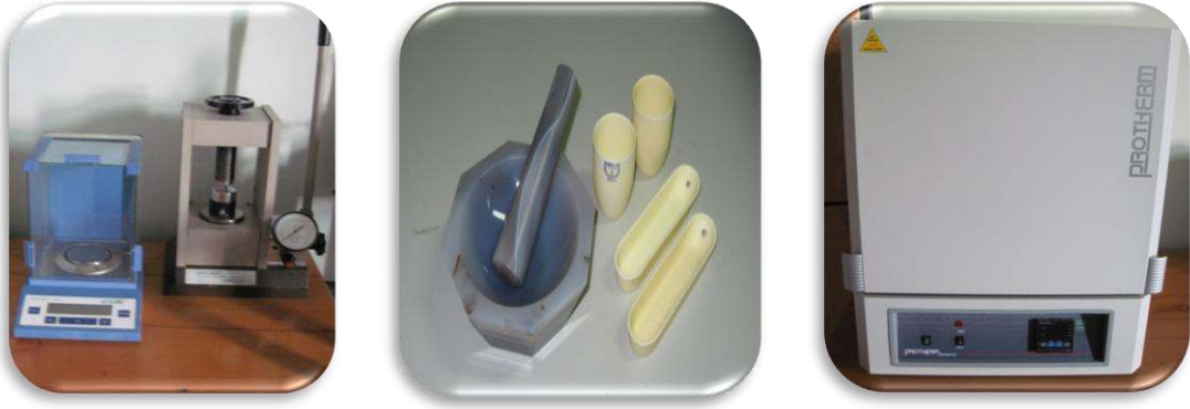
Şekil 7.1 Örnek hazırlarken kullanılan ölçüm cihazları ve fırın.
