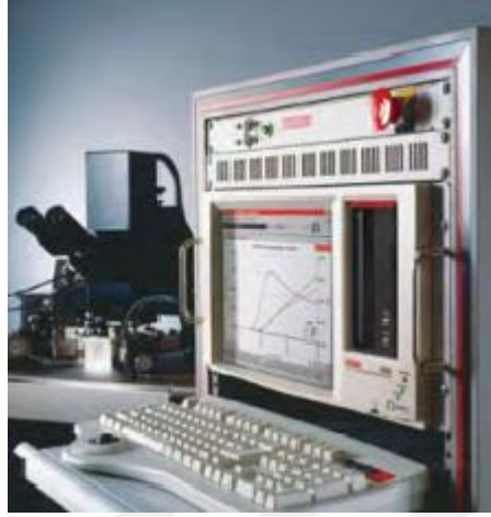
Şekil 0.6. Keithley 4200 SCS yarıiletken karakterizasyon sistemi
