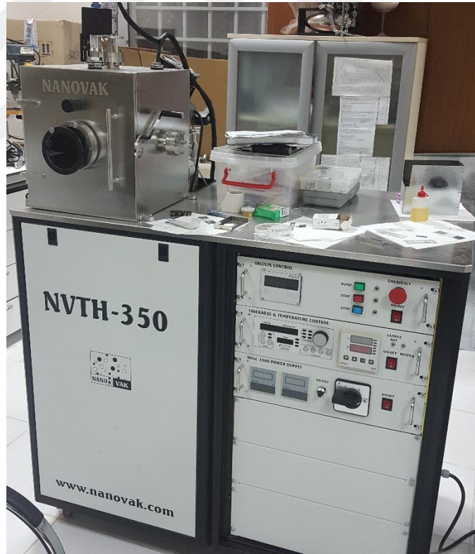
Şekil 0.5. Nanovak NVTH-350 termal buharlaştırma sistemi
