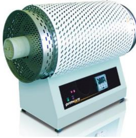
Şekil 3.2. 0-1200 °C ayarlanabilir Protherm PTF 12/75/800 tüp fırın
