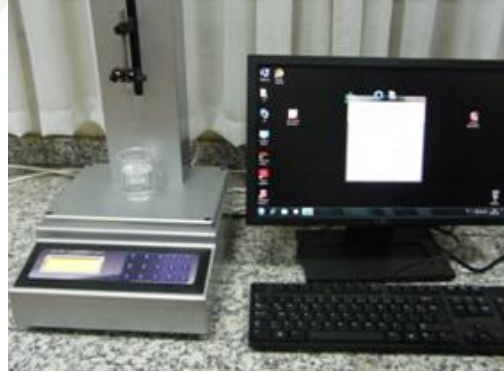
Şekil 3.3. Holmarck daldırma kaplama cihazı
