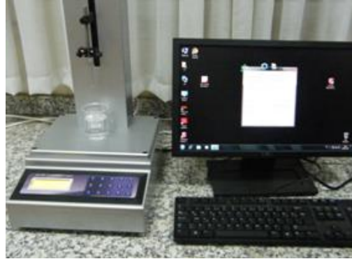
Şekil 3.3. Holmarck daldırma kaplama cihazı
