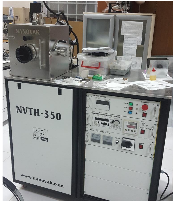
Şekil 0.5. Nanovak NVTH-350 termal buharlaştırma sistemi
