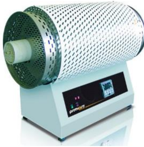
Şekil 3.2. 0-1200 °C ayarlanabilir Protherm PTF 12/75/800 tüp fırın
