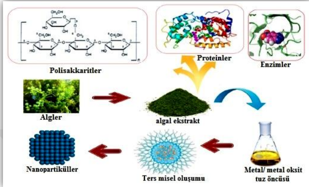
Şekil 2.10. Algler kullanılarak nanopartiküllerin biyosentez akışı (Sharma vd. 2015)
