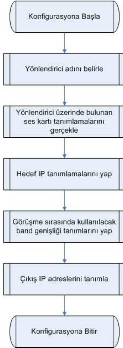
Şekil 7.9 B kampüsü yönlendiricisi üzerinde yapılacak konfigürasyonun blok diyagramı
