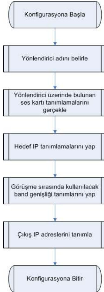
Şekil 7.8 A kampüsü yönlendiricisi üzerinde yapılacak konfigürasyonun blok diyagramı
