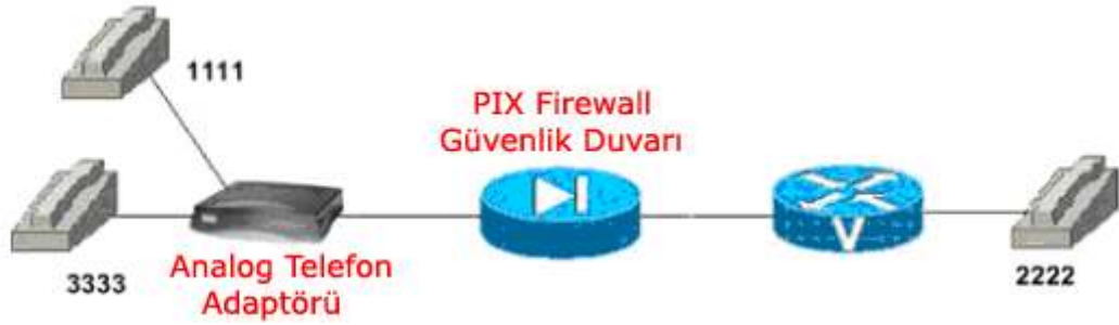
Şekil 7.10 Güvenlik duvarı ile VoIP trafiğinin kontrolü [46]
