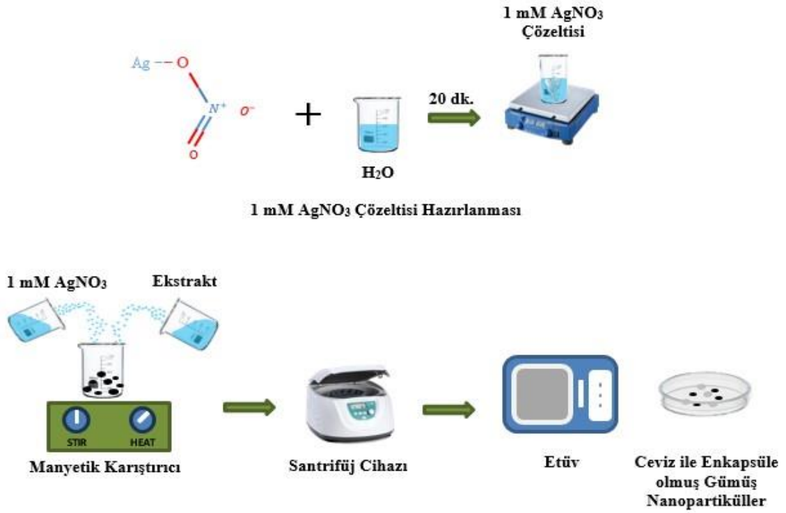
Şekil 3.14. Yeşil ceviz kabuğu ekstraktı ile enkapsüle Ag nanoparçacıklar hazırlanması akış diyagramı
