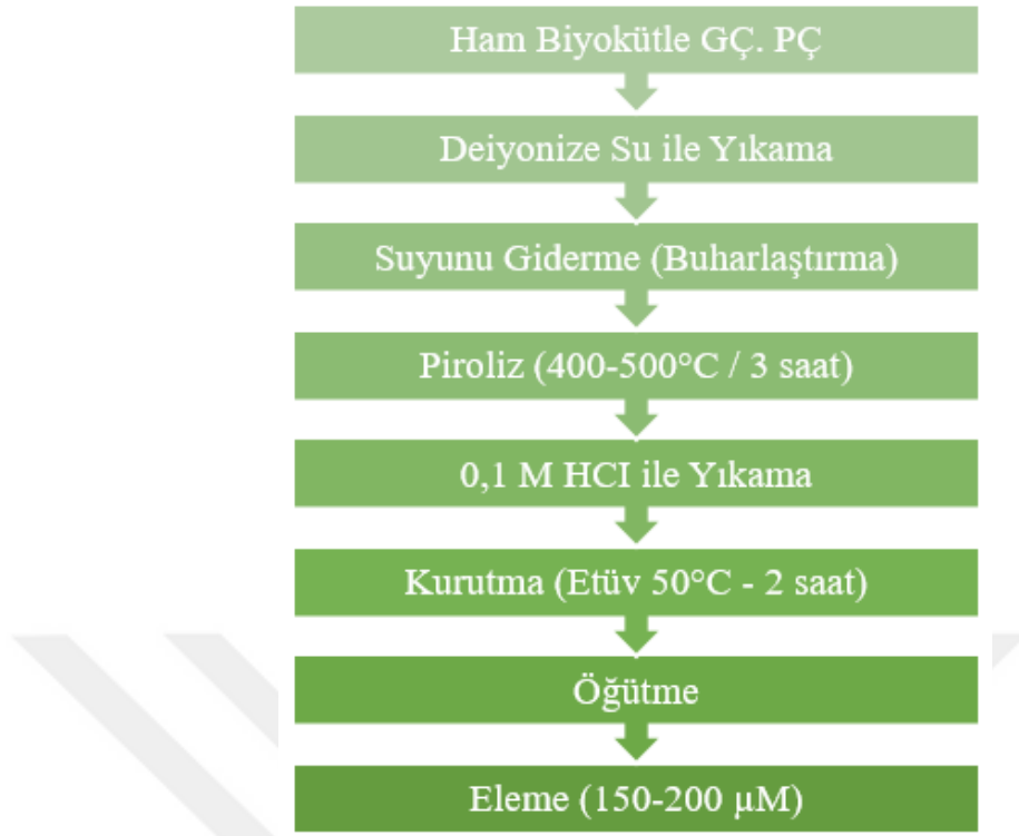
Çizelge 3.1. Adsorbanlar ile Biyoçar Eldesi Akış Şeması
