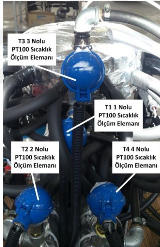
Şekil 3.20. PT100 sıcaklık ölçüm elemanlarının deney sistemi üzerindeki yerleşimi
