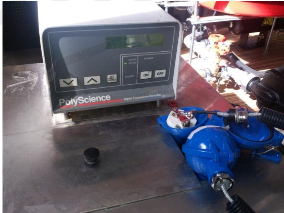
Şekil 3.21. PT100 Sıcaklık Transmitterleri için Kalibrasyon İşlemi
