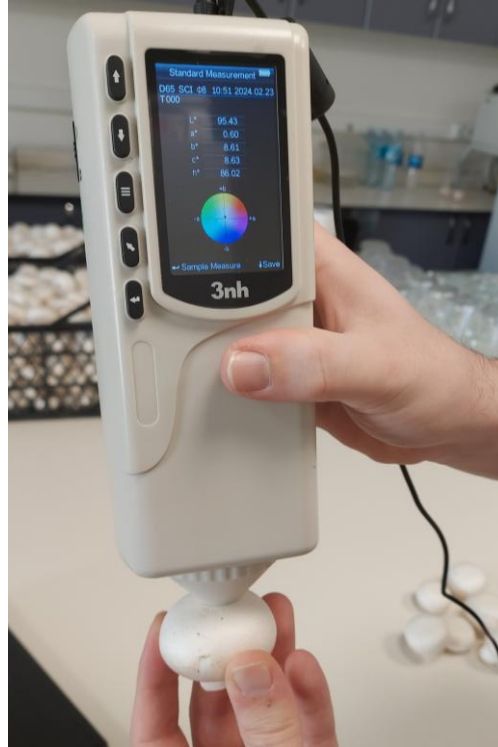
Fotoğraf 2.9. Mantar renginin ölçümü
