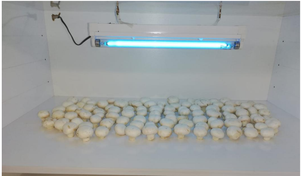
Fotoğraf 2.2. UV-B ve UV-C uygulamalarının yapılışı
