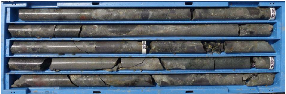
Şekil 2.2. Akyazı Tüneli güzergahında açılmış olan sondaj kuyusuna ait karot sandığı fotoğrafı [30].
