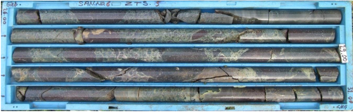
Şekil 2.4. Zigana Tüneli güzergahında açılmış olan sondaja ait karot sandığı fotoğrafı [31].
