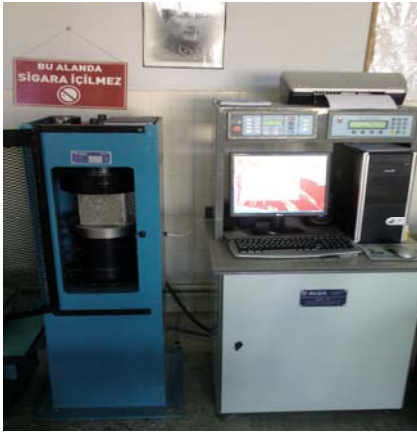
Resim 3.8 Beton test presi ve beton numunesi
