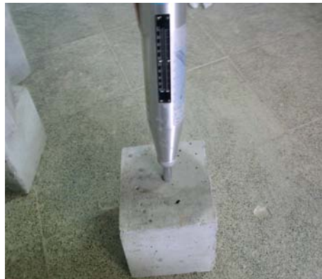
Resim 3.5 Schmidt  ekici ve Deneyin Yapılı ı
