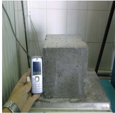
Resim 3.8 Beton test presi ve beton numunesi
