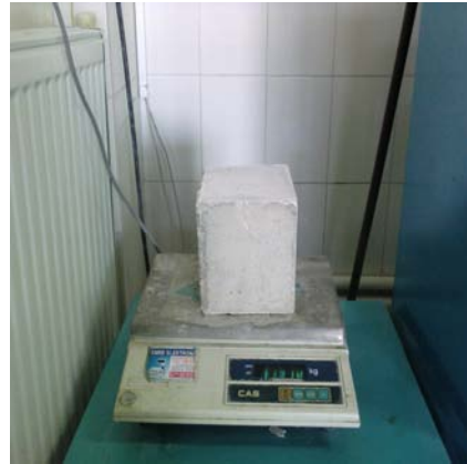
Resim 3.7 Su emme deneyin yapılışı
