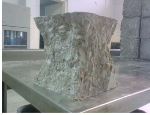
Resim 3.9 Basınç Deneyine Tabi Tutulmuş Numune
