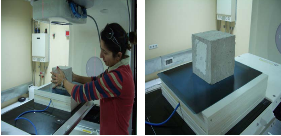
Resim 3.15 Numunelerin ölçüm için yerleştirilmeleri
