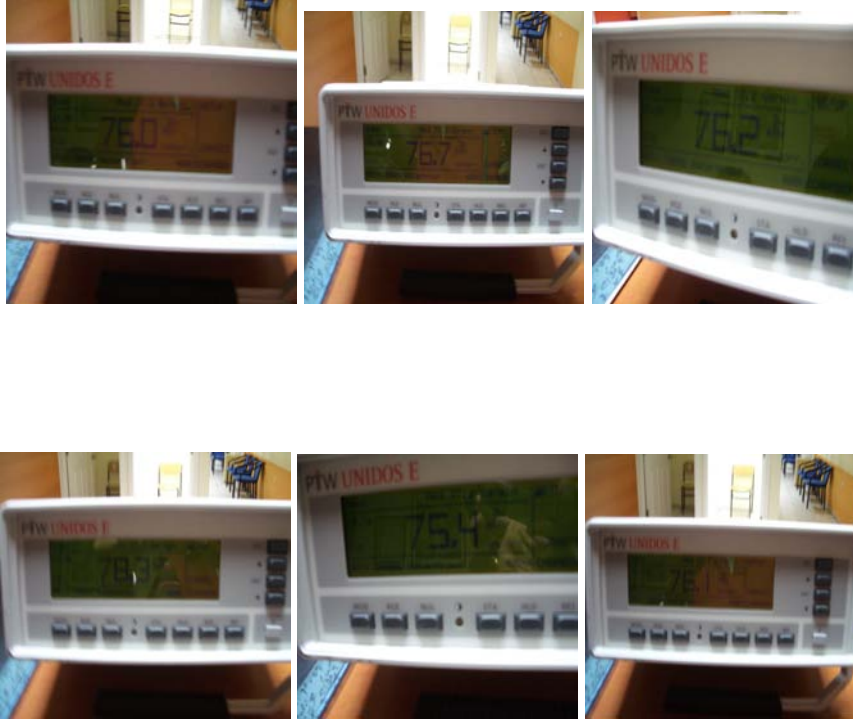
Resim 3.17 Elektrometre cihazında numunelerin ölçüm sonuçları
