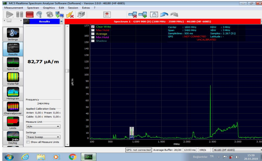
Şekil 4. 3. Akıllı tahtadan 1 cm uzaklıkta elde edilen manyetik alan ölçümü değeri
