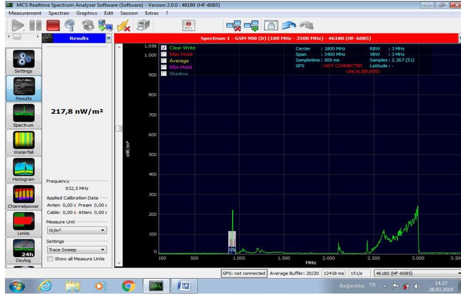
Şekil 4. 12. Akıllı tahtadan 30 cm uzaklıkta elde edilen eşdeğer düzlem dalga güç yoğunluğu ölçümü değeri
