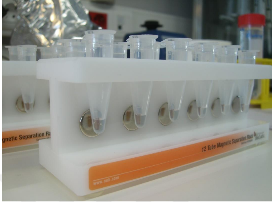
Şekil 3.8. PZR ürünlerinin AmPure boncukları ile manyetik tutucu raf üzerinde temizlenmesi
