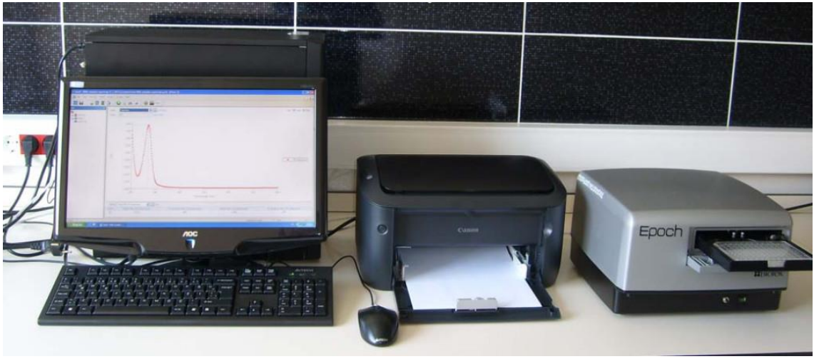
Şekil 3.1. UV/Görünür alan Mikroplaka spektrofotometresi (BioTek Epoch)
