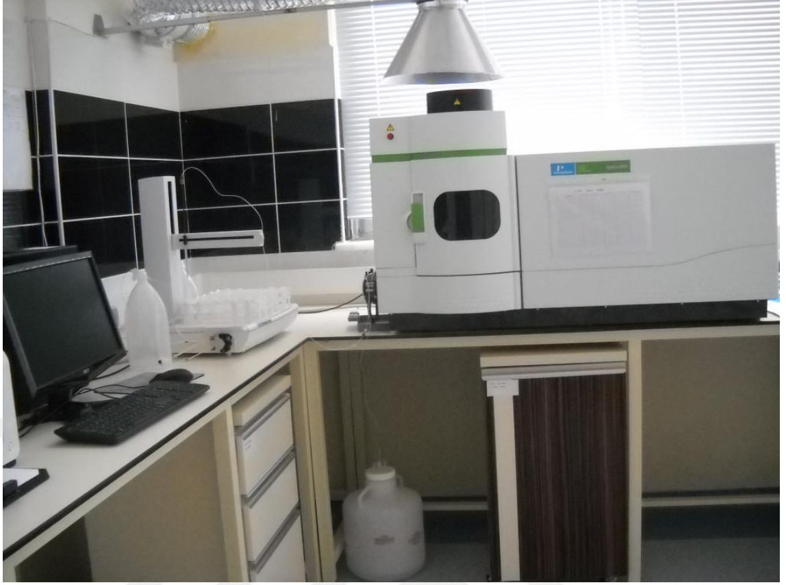
Şekil 3.2. ICP-OES cihazı (Perkin Elmer, Optima)
