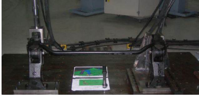
Şekil 5.2 : Mevcut denge çubuğunun rijitlik ölçümü.
