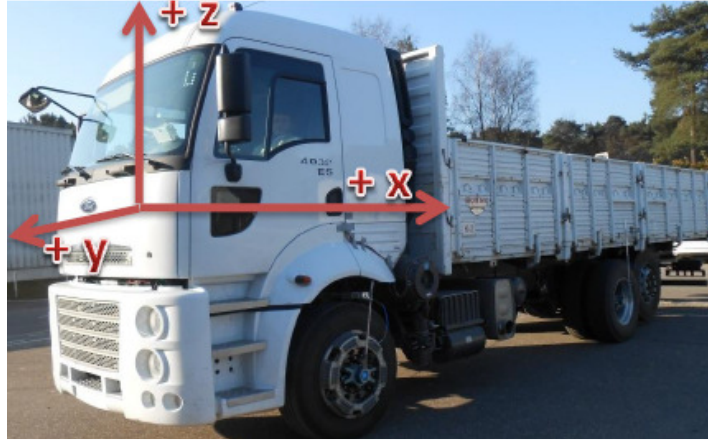
Şekil 5.11 : Test aracı ve koordinat sistemi.
