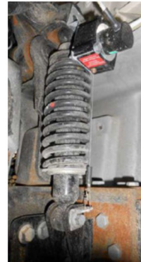
Kabin amortisörlerinden deplasman ölçümü
