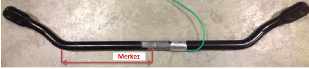
Şekil 5.9 : Kabin denge çubuğuna strain gage uygulaması.
