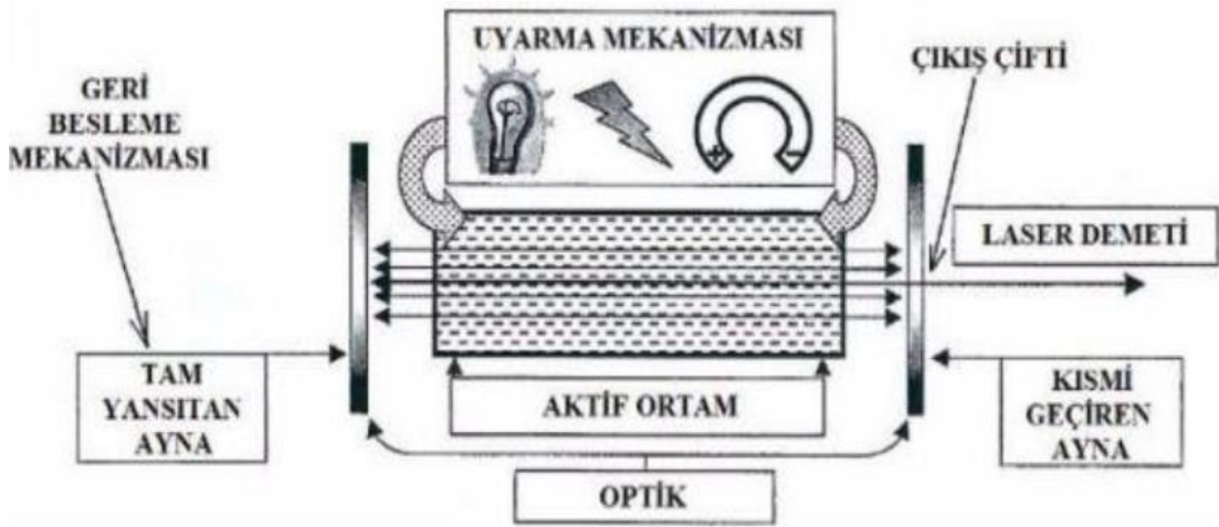
Şekil 2.3. Lazer sisteminin şematik gösterimi (Silfvast 2004).
