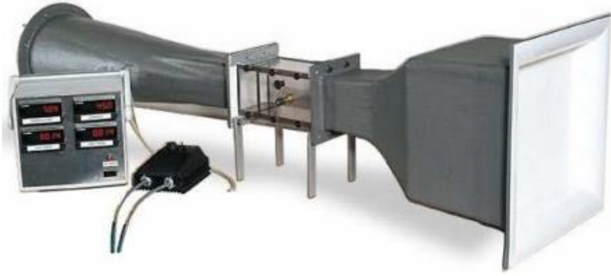
Resim 2.1 Açık devre rüzgâr tüneli (Kaykisizli 2006).
