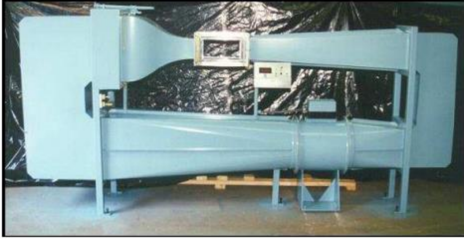
Resim 2.2 Kapalı devre rüzgâr tüneli (Kaykisizli 2006).
