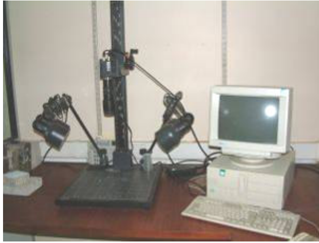
Şekil 5.29 Görüntüleme sistemi, (Imperial College London)
