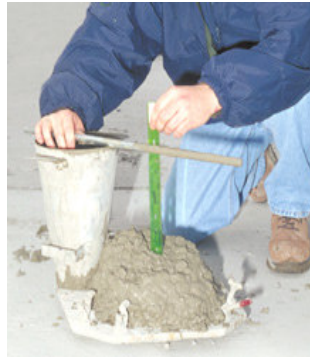
(a) Çökme deneyi
