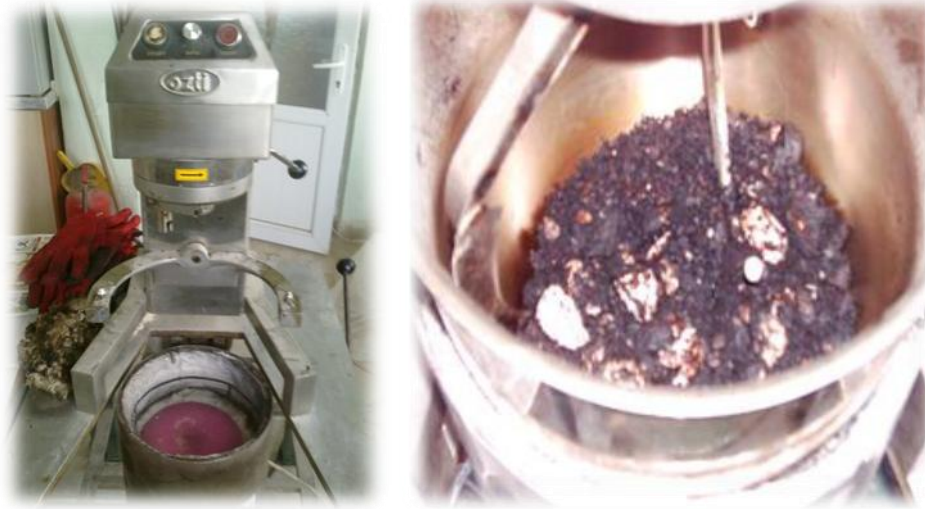
Resim 3.15. Çalışmalarda kullanılan ısıtıcılı mekanik asfalt karıştırıcısı ve bir karıştırma işlemi
