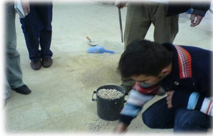
Resim 3.3. Sıkıřık birim ağırlık tayini deney yapımı
