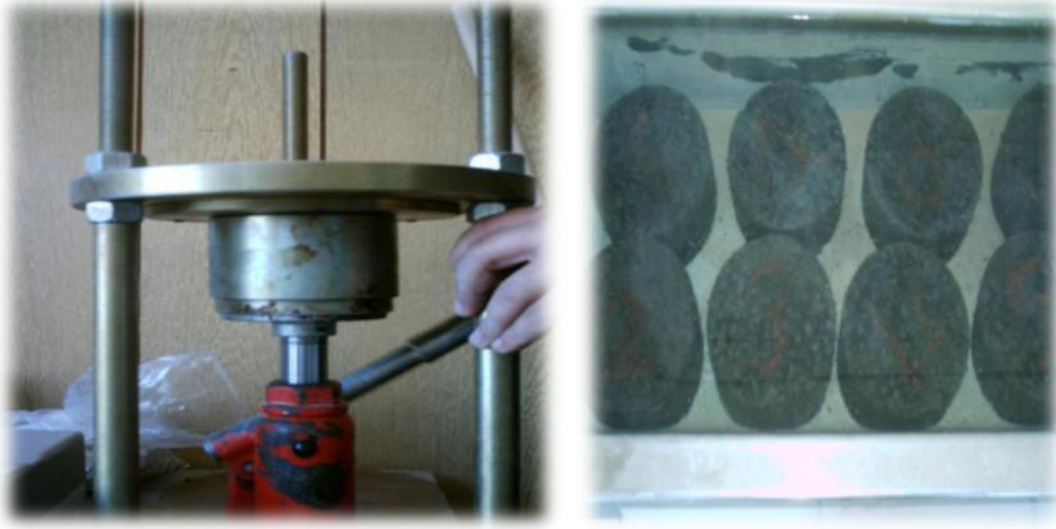
Resim 3.17. Hidrolik numune çıkarıcı ve su banyosu
