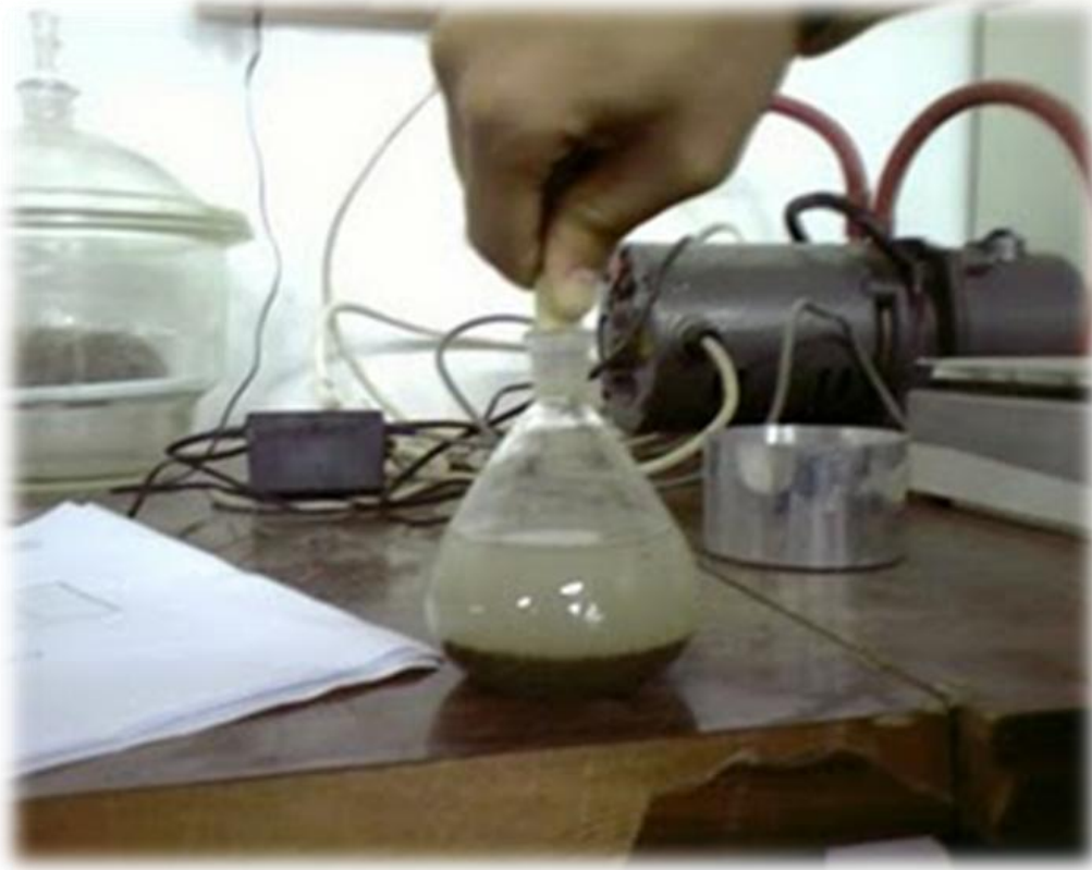
Resim 3.2. Kap içerisinde bulunan havanın alımı
