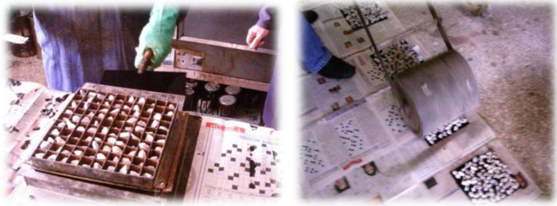
Resim 3.20. Mekanik sericiye yerleştirilmiş ve silindirme esnasındaki numuneler
