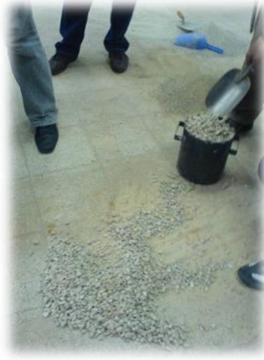
Resim 3.4. Gevşek birim ağırlık tayini deney yapımı
