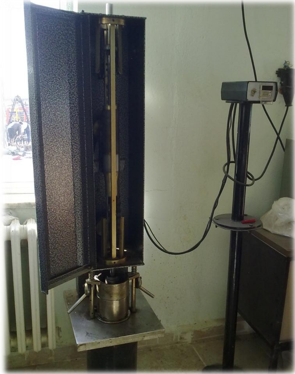
Resim 3.16. Çalışmada Marshall deney numunelerini hazırlamak için kullanılan otomatik tokmak
