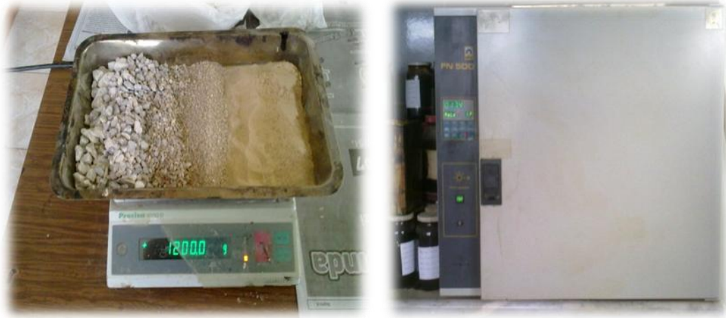
Resim 3.14. 1200 gr’lık karışım tartımı, aparat ve karışımların ısıtılması
