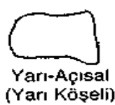
Şekil 2.3. Agreg a tane biçim sınıflandırılması (2 boyutlu)
