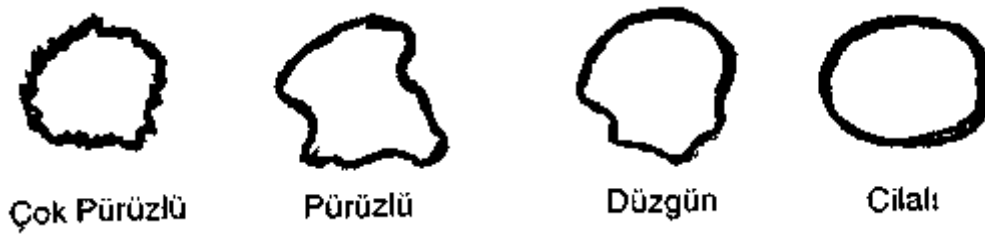
Şekil 2.5. Yüzey yapısı sınıflandırması
