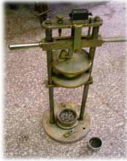
Resim 3.6. Agregada darbelenme değeri tayini için deney cihazı
