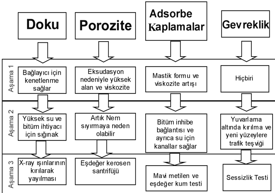
Şekil 2.14. Agregaların dayanım ve soyulması üzerindeki etkiler ve uygulanabilecek test yöntemleri
