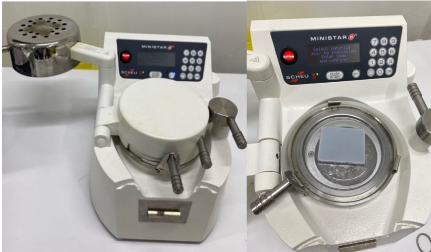
Şekil 3-2: Ministar S (Scheu Dental) plak vakum cihazı.
