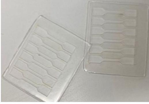
Şekil 3-5: Kare kalıplara basılmış plaklar üzerinden lazer kesimle çekme deneyine uygun numunelerin elde edilmiş hali
