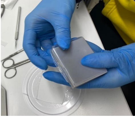
Şekil 3-3: Plakların kare kalıplara basılmış hali.
