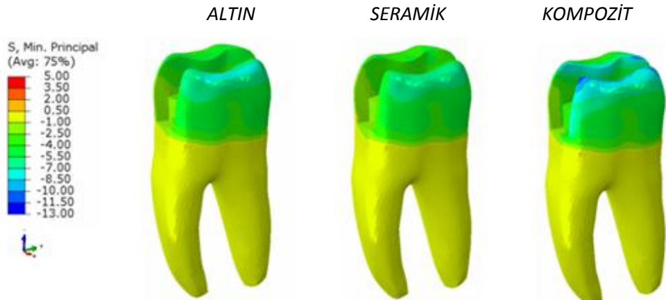
Şekil 4.10: 4 °C sıcaklık uygulaması sonucu dentinde 2. saniyede oluşan basma (Smin) stres dağılımı
