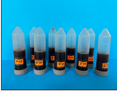
Resim 22. Kahve solüsyonlu plastik konik tüplere yerleştirilmiş örnekler
