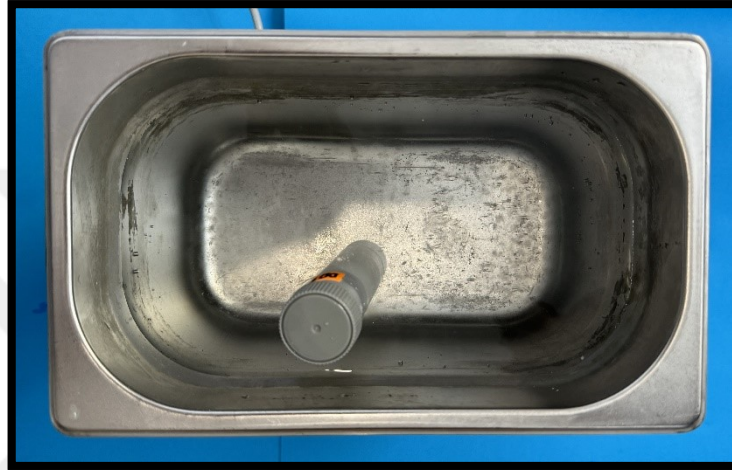
Resim 26. Tüplerin ultrasonik cihaz yardımıyla çalkalanması
