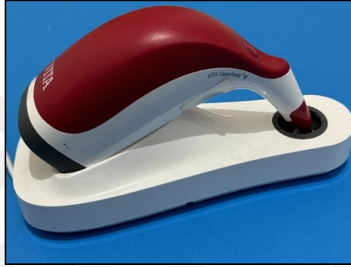
Resim 20. Renk ölçümünde kullanılan spektrofotometre
