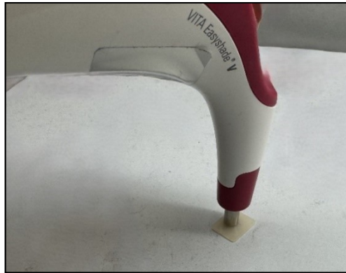
Resim 21. Nötral gri zemin üzerinde ölçümlerinin yapılması
