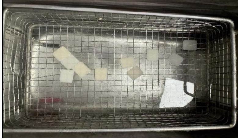
Resim 3. Örneklerin ultrasonik temizleyicide temizlenmesi
