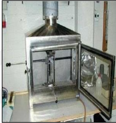
Şekil 3.7. Kapalı Deney düzeneği (TS11925-2, 2003)
