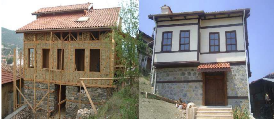
Şekil 4.8 Kerpiç dolgulu (soldaki) ve sıvalı (sağdaki) ahşap karkas sistem örnekleri (Tunca, 2019)
