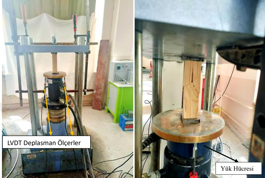
Şekil 3.11. Liflere paralel basınç deney düzeneği.
