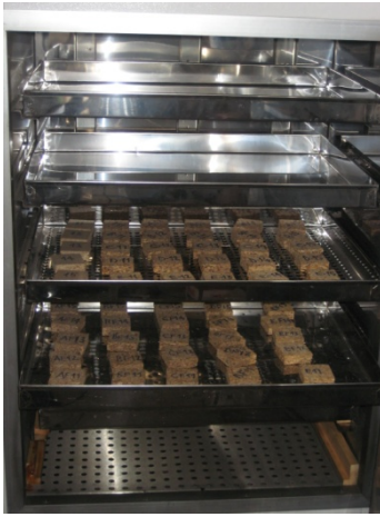
Resim 4.2. Deney örneklerinin etüve konulması.
