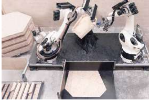
Şekil 5. Robotik üretim ile gerçekleştirilen karşılıklı çerçeve ahşap blok eleman, BUGA Ahşap Pavyonu (URL-4)
