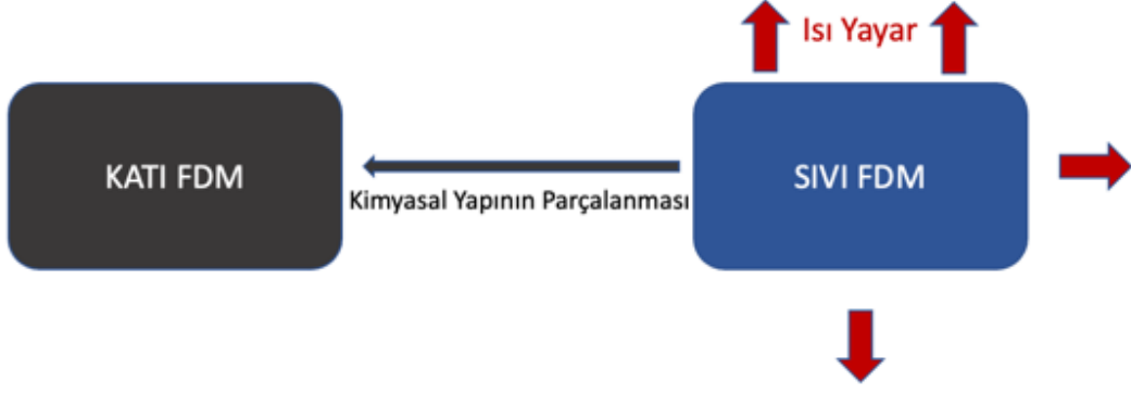
Şekil 14. FDM'nin sıvıdan katıya faz değişimi
