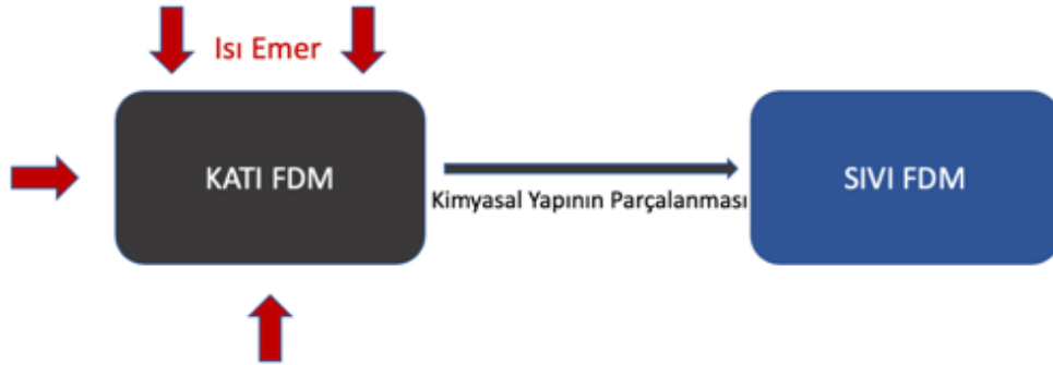
Şekil 13. FDM'nin katıdan sıvıya faz değişimi
