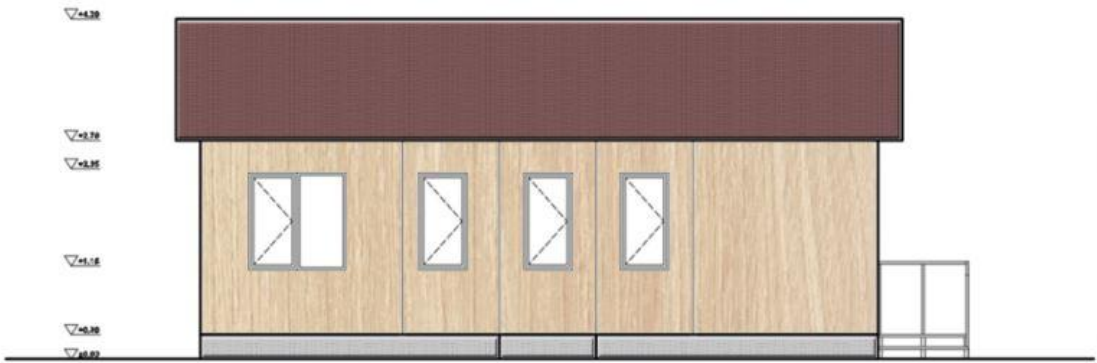
Şekil 62. 5-6 kişilik geçici afet konutu batı cephesi görünüşü
