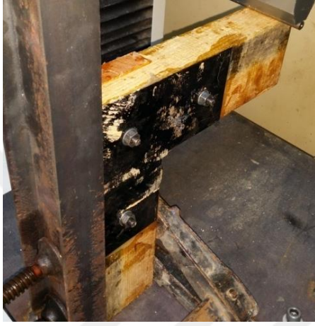
Şekil 6.63. Çekme-eğilme makinesine bağlanmış CFRP levhalı L birleştirme numunesi
