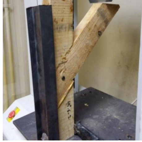
Şekil 6.92. Deney sonrası ham 45° gönye birleştirme numunesi
