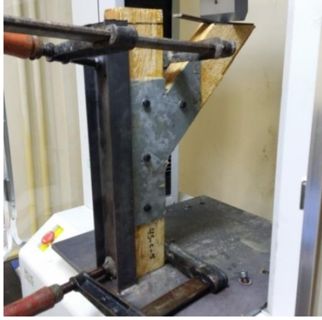
Şekil 6.103. Çekme-eğilme makinesine bağlanmış GFRP levhalı 45° birleştirme numunesi
