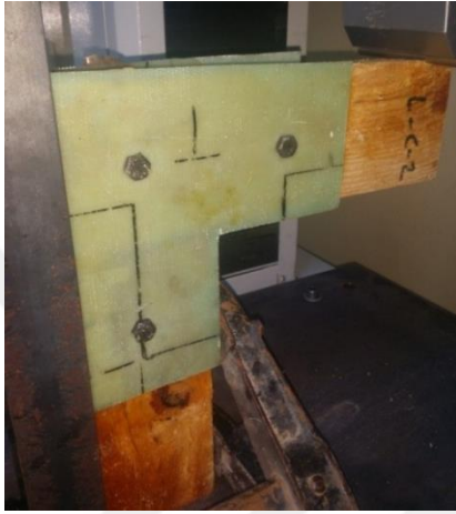
řekil 6.67. Çekme-eğilme makinesine bağlanmış GFRP levhalı L birleřtirme numunesi
