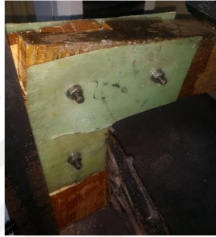
řekil 6.68. Deney sonrası GFRP levhalı L birleřtirme numunesi
