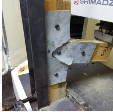
Şekil 6.86. Deney sonrası GFRP levhalı T birleřtirme numunesi
