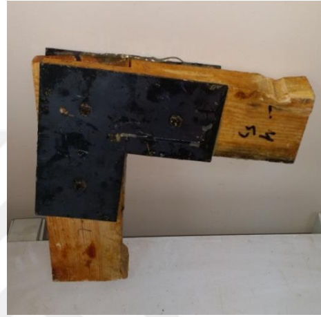
Şekil 6.60. Deney sonrası metal levhalı L birleřtirme numunesi
