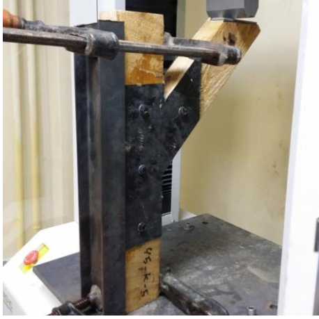
Şekil 6.99. Çekme-eğilme makinesine bağlanmış CFRP levhalı 45° birleştirme numunesi
