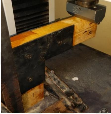
Şekil 6.59. Çekme eğilme makinesine bağlanmış metal levhalı L birleřtirme numunesi
