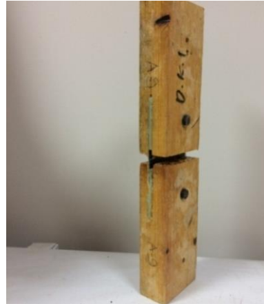
Şekil 6.46. Deney sonrası CFRP levhalı yabancı zıvanalı birleştirme numunesi
