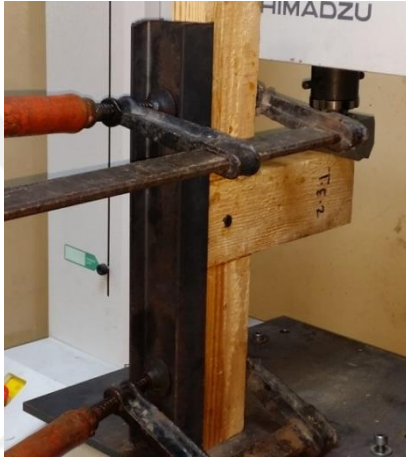
řekil 6.73. Çekme eęilme makinesine baęlanmış ham T tipi birleřtirme numunesi
