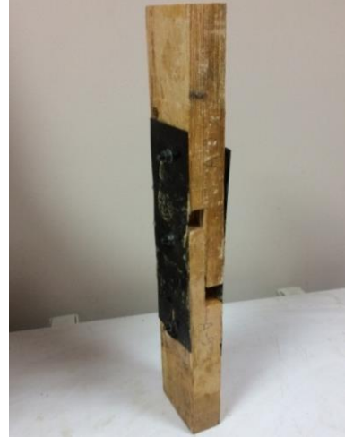
Şekil 6.10. Deney sonrası CFRP kertmeli boy birleştirme numunesi
