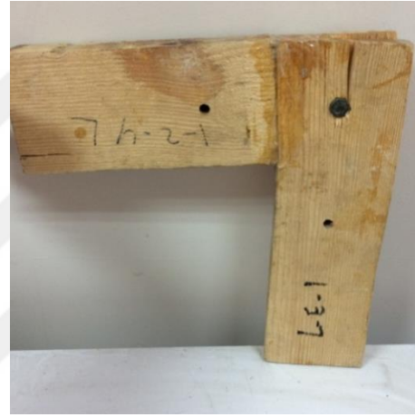
Şekil 6.56. Deney sonrası ham L tipi birleřtirme numunesi
