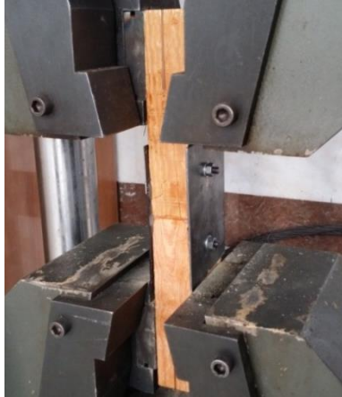
Şekil 6.23. Çekme makinesine bağlanmış metal levhalı uç uca birleştirme numunesi
