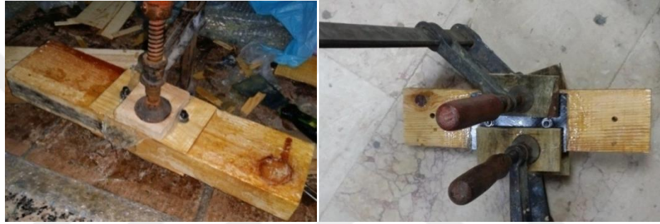
Şekil 4.6. İşkenceler kullanarak boy birleştirme numuneleri preslenmesi
