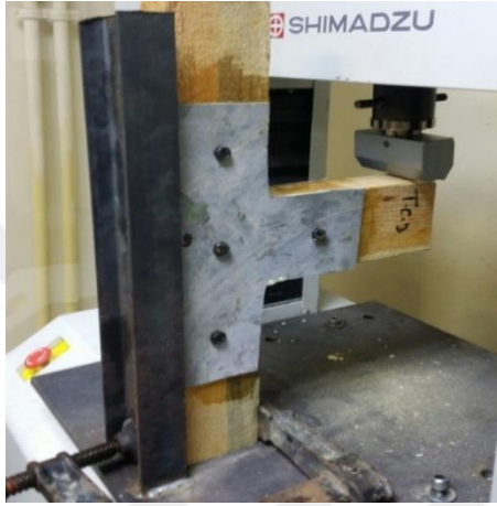
Şekil 6.85. Çekme-eğilme makinesine bağlanmış GFRP levhalı T birleřtirme numunesi
