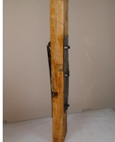
Şekil 6.5. Deney sonrası metal levhalı kertmeli birleştirme numunesi
