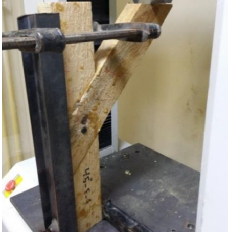
Şekil 6.91. Çekme-eğilme makinesine bağlanmış ham 45° gönye birleştirme numunesi
