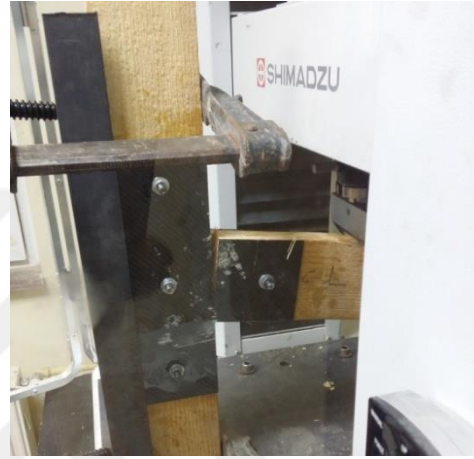
Şekil 6.82. Deney sonrası CFRP levhalı T birleştirme numunesi
