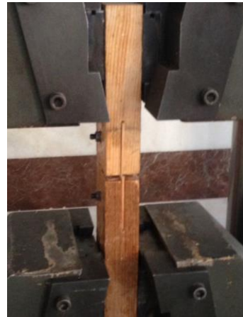
Şekil 6.38. Deney sonrası ham yabancı zıvanalı birleştirme numunesi
