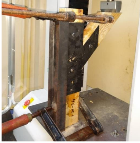
Şekil 6.95. Çekme-eğilme makinesine bağlanmış metal levhalı 45° birleştirme numunesi
