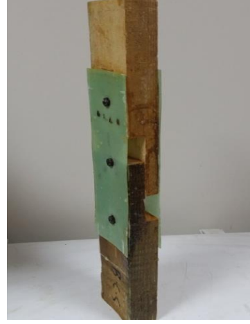
Şekil 6.14. Deney sonrası GFRP levhalı kertmeli birleştirme numunesi
