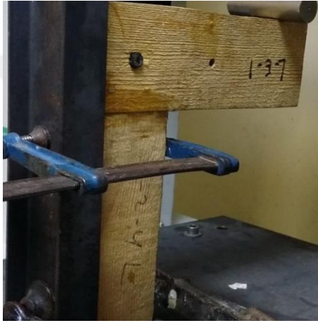
Şekil 6.55. Çekme-eęilme makinesine baęlanmış ham L tipi birleřtirme numunesi
