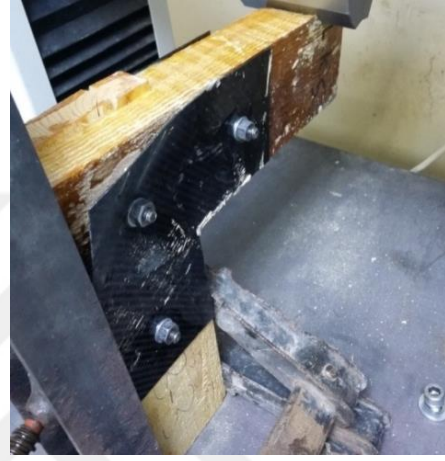
Şekil 6.64. Deney sonrası CFRP levhalı L birleştirme numunesi
