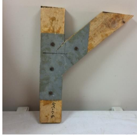
Şekil 6.104. Deney sonrası GFRP levhalı 45° birleştirme numunesi
