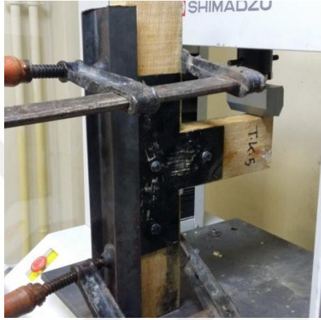
Şekil 6.81. Çekme-eğilme makinesine bağlanmış CFRP levhalı T birleştirme numunesi
