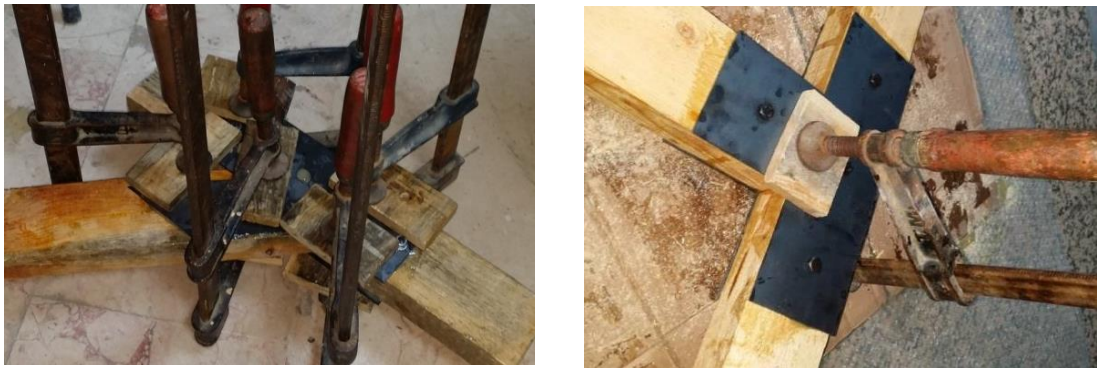
Şekil 4.11. İşkenceler kullanarak T ve 45° gönye numuneleri preslenmesi
