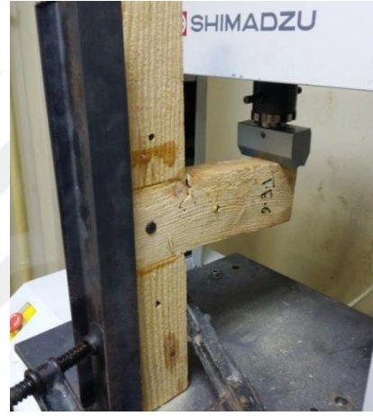
řekil 6.74. Deney sonrası ham T tipi birleřtirme numunesi
