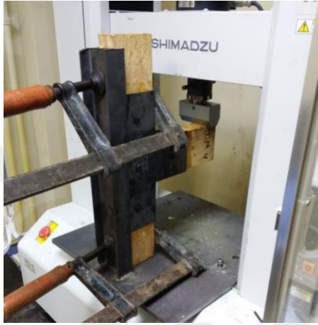
Şekil 6.77. Çekme eğilme makinesine baėlanmıř metal levhalı T birleřtirme numunesi
