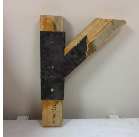
Şekil 6.96. Deney sonrası metal levhalı 45° birleştirme numunesi
