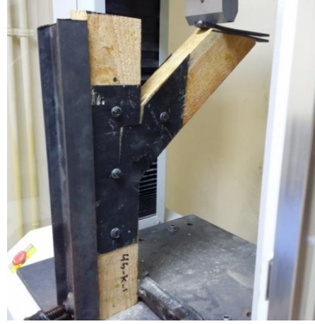
Şekil 6.100. Deney sonrası CFRP levhalı 45° birleştirme numunesi
