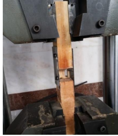
Şekil 6.24. Deney sonrası metal levhalı uç uca birleştirme numunesi
