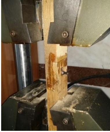
Şekil 6.1. Çekme makinesine bağlanmış Ham kertmeli boy birleştirme numuneleri
