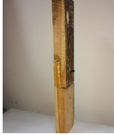
Şekil 6.1. Deney sonrası ham kertmeli boy birleştirme numuneleri
