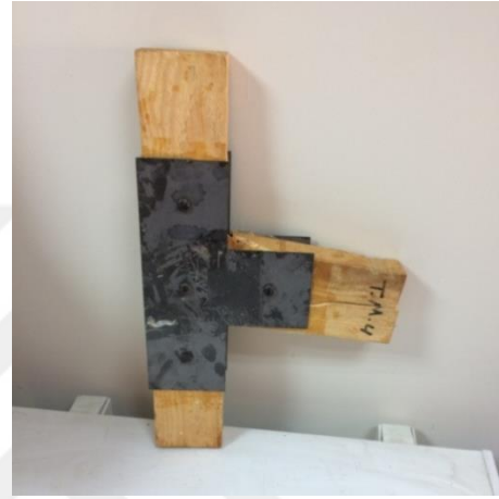
Şekil 6.78. Deney sonrasımatal levhalı T birleřtirme numunesi
