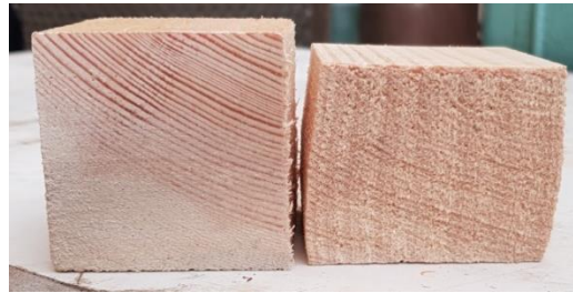
Şekil 2.5 5 cm küp ahşap numunenin liflere dik basınç yüklemesi öncesi ve sonrası (Kişisel Arşiv, 2019)
