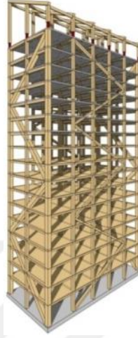
Şekil 1.5 Mjøstårnet taşıyıcı sistemi-Norveç (Abrahamsen, 2017)
