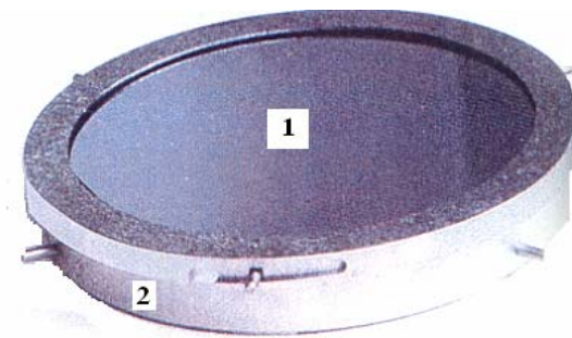
Resim 4.2 3-inch indiyumsuz alttaş tutucu: 1. alttaş ve 2. alttaş tutucu
