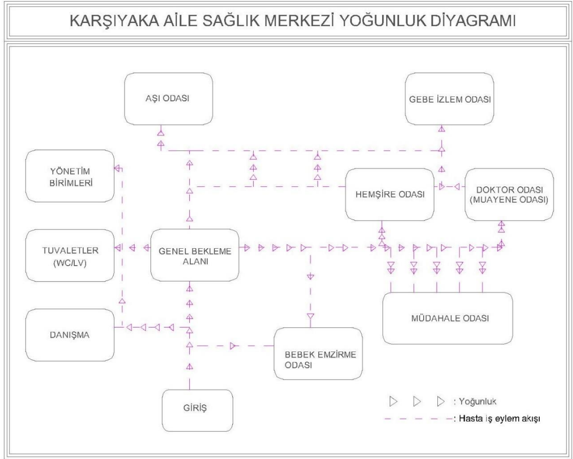
Şekil 4.32. Karşıyaka Aile Sağlık Merkezi hasta eylem akış diyagramı
