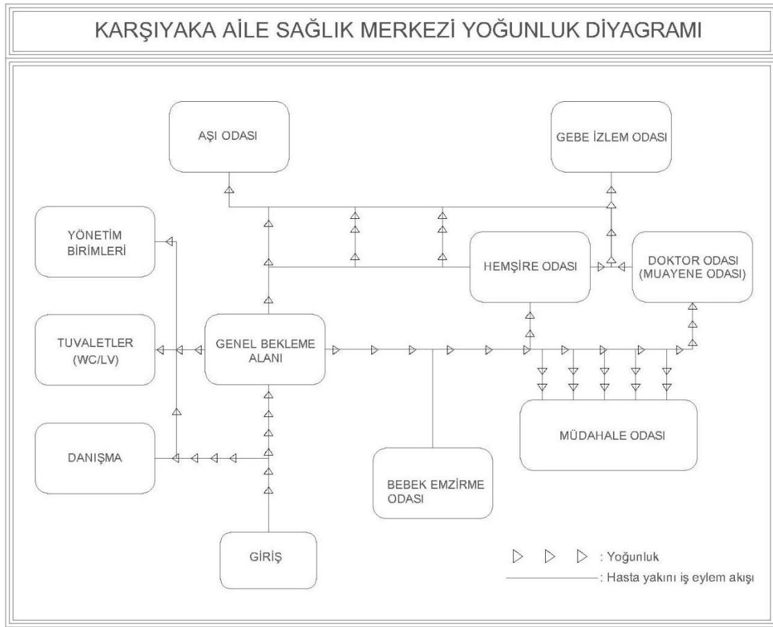
Şekil 4.33. Karşıyaka Aile Sağlık Merkezi hasta yakını eylem akış diyagramı
