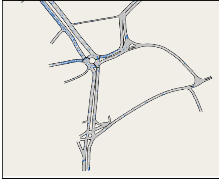
Şekil 61. Aimsun senaryo 1 Taşhan Kavşağı tasarımı simülasyon modellemesi
