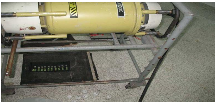
Şekil 8.14.Film, penetremeter, şablonlu kalıp, ışın kümesi [84].
