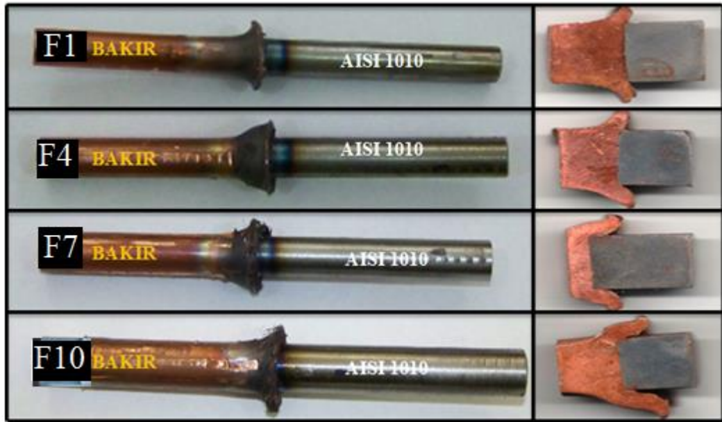
Şekil 9.3. S1, S4, S7 ve S10 no'lu numunelere ait yüzey ve ara yüzey fotoğrafları
