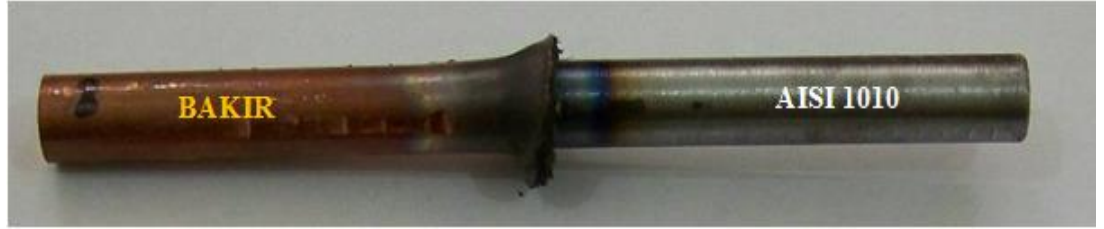
Şekil 9.1. Kaynak bölgesinde oluşan flanş ve IEB’ nin gösterimi
