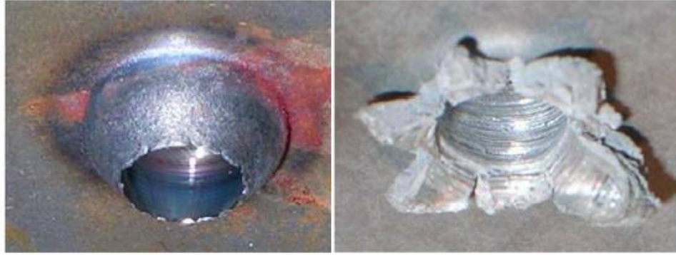
Şekil 2. 18 Sürtünmeli delmede oluşan kovan yapıları [8].
