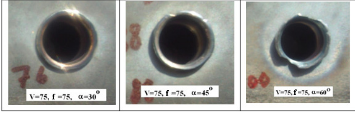
Şekil 4. 20 Matkap uç açısının pul geometrisi üzerindeki etkisi
