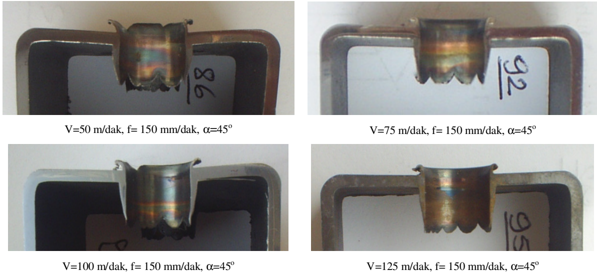
Şekil 4.24 Delme hızının petal geometrisi üzerindeki etkisi( d=10 mm)
