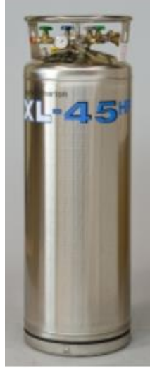
Şekil 8.5. Taylor WhartonXL-45 HP sıvı azot tankı.
