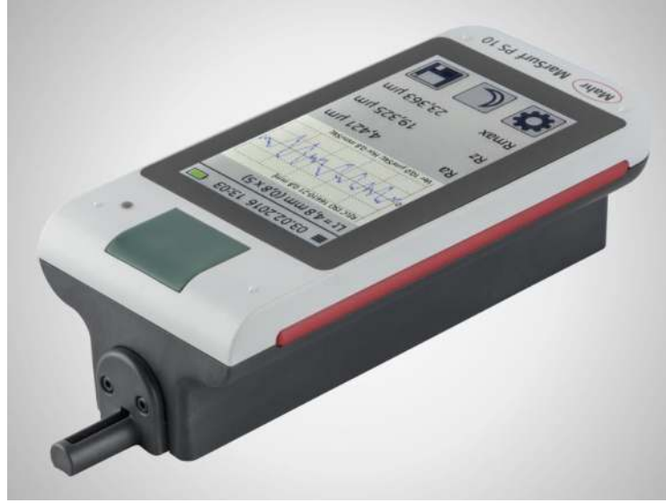
Şekil 8.7. MarSurf PS10 taşınabilir yüzey ölçüm cihazı.
