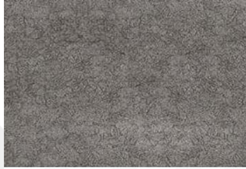
Şekil 2.4. Martenzitik paslanmaz çeliğin mikro yapısı [37].
