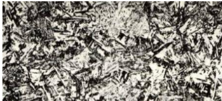
Şekil 2.5. Çökelme sertleşmeli paslanmaz çeliğin mikro yapısı [41].
