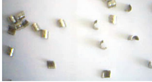
Resim 6.3. İşleme sonrası talaş biçimleri ( V_3=180 m/min, f_2=0,24 mm/rev, a=2,5 mm)
