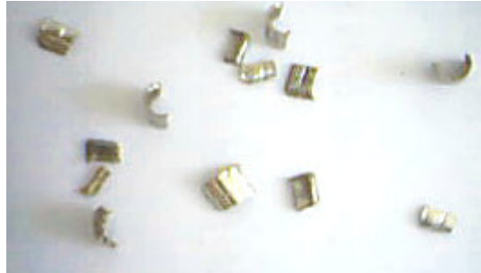
Resim 6.4. İşleme sonrası talaş biçimleri ( V_4=210 m/min, f_2=0,24 mm/rev, a=2,5 mm)
