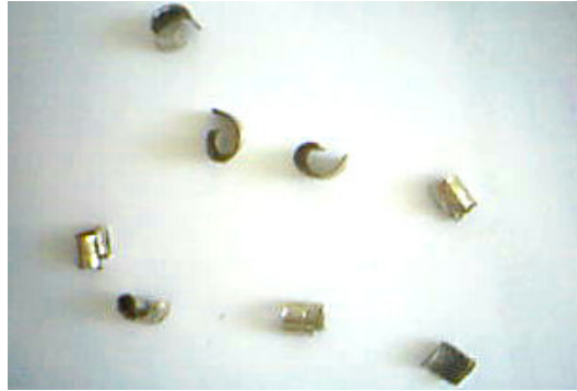
Resim 6.5. İşleme sonrası talaş biçimleri ( V_2=150 m/min, f_1=0,20 mm/rev, a=2,5 mm)
