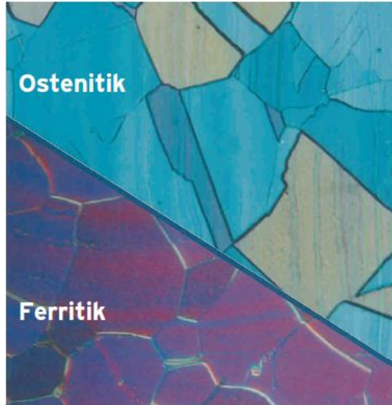
Şekil 2.3 Östenitik ve ferritik paslanmaz çelik türlerinin içyapıları (Aran ve Temel 2004).
