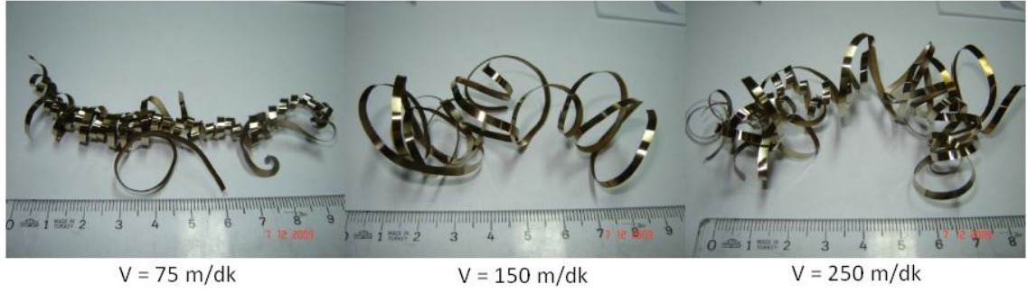
Resim 6.8 Kesme hızının talaş şekli üzerindeki etkisi ( f = 0,05 mm/dev, Al_2O_3 ).
