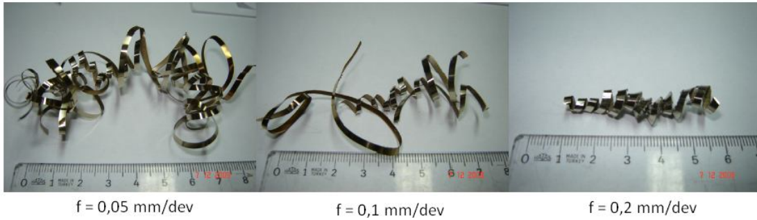
Resim 6.3 İlerlemenin talaş şekli üzerindeki etkisi ( V= 250\text{m/dak} , \text{Al}_2\text{O}_3 ).
