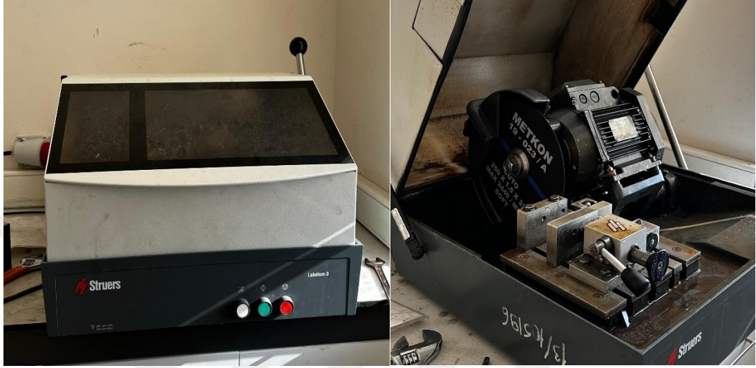
Şekil 6.7. Numune kesme işlemi ve Struers-Labotom-3 marka kesme makinesi
