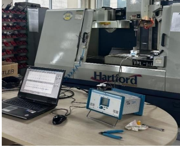
Şekil 6.4. Kistler Tip 9257B marka 3 Eksen Dinamometre
