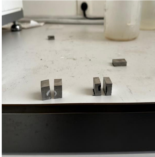
Şekil 8. Struers-Labotom-3 kesme makinesi ile kesilmiş numuneler
