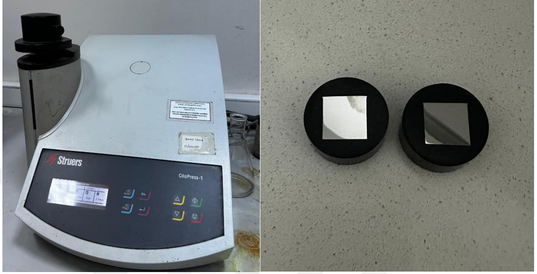
Şekil 6.9. Struers CitoPress-1 sıcak bakalite alma cihazı ve numuneler
