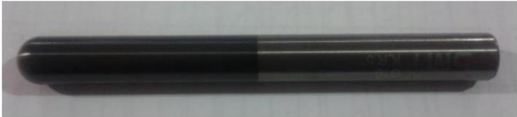
Şekil 6.2. Krom Karbo-Nitrür Kaplama (CrCN)(Müftüoğlu, 2014)
