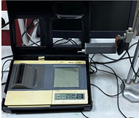
Şekil 6.13. Mitutoyo SJ 301 marka yüzey pürüzlülüğü ölçme cihazı
