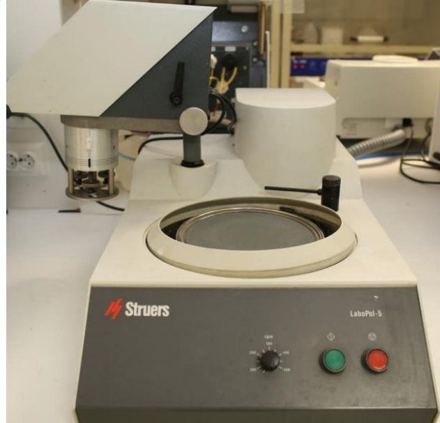
Şekil 6.10. Struers LaboPol-5 marka zımparalama ve parlatma cihazı
