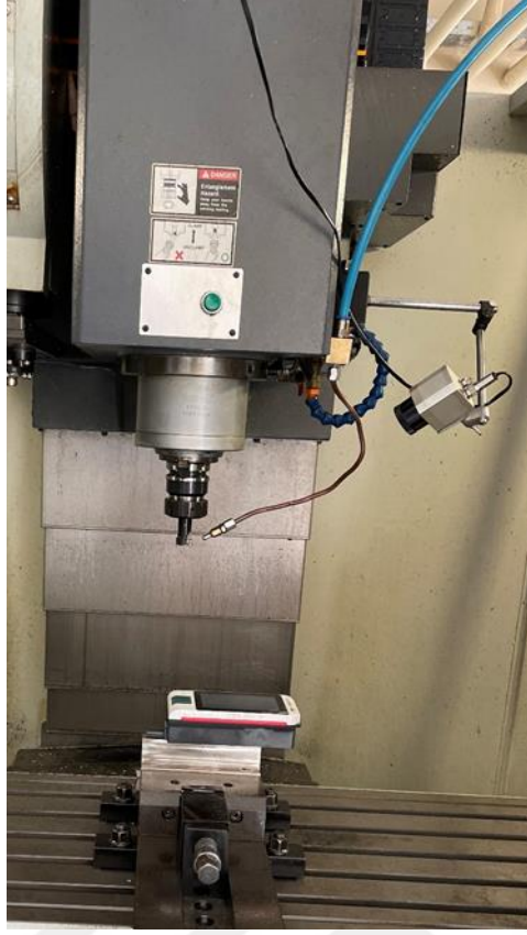
Şekil 8.2. Kesme sıcaklığı ve yüzey pürüzlülüğü ölçümü.
