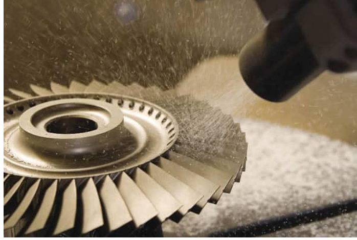
Şekil 3.15. Dişli bir parçaya yapılan kumlama işlemi.
