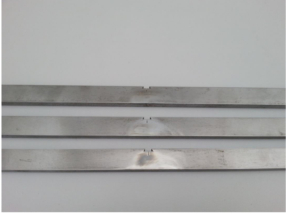
Şekil 5.4a: Tel erezyonda kırangıç yuvası ve yapay çatlak açtırılan kirişler
