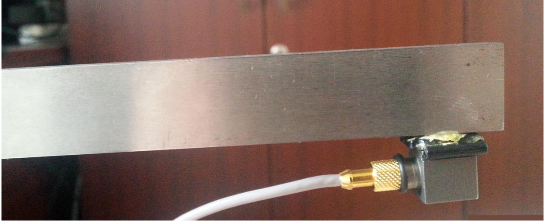
Şekil 5.20: Kiriş üzerine monte edilen ivmeölçer
