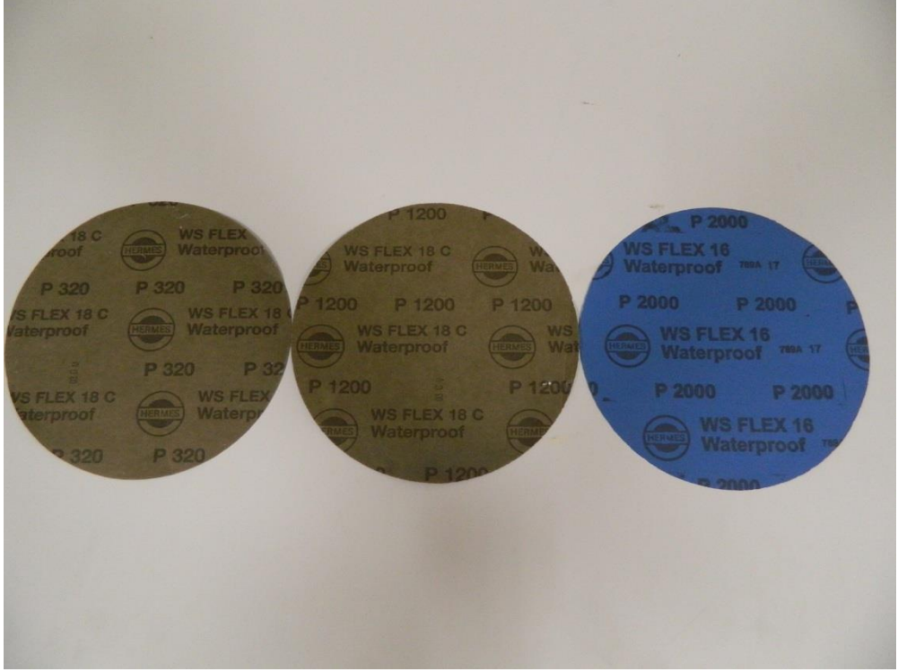
Şekil 5.5b: Çatlak yüzeylerini parlatma işleminde kullanılan 320, 1200 ve 2000 meş zımparalar
