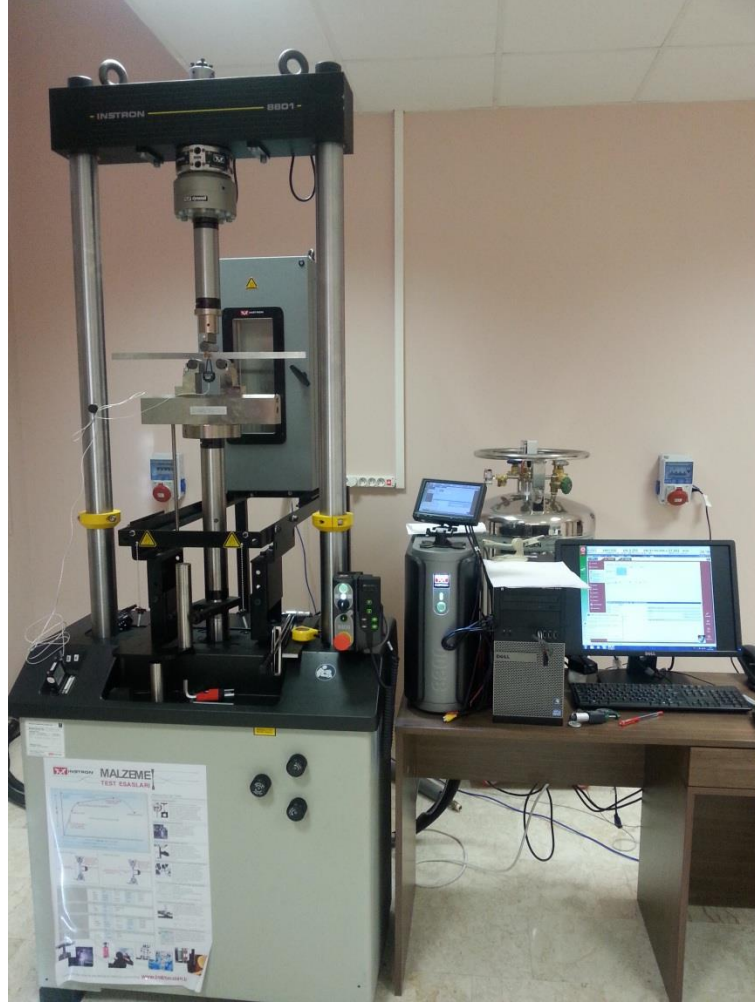
Şekil 5.28b: Yorulma çatlaklı ilerlemesi deneyi sırasında kirişlere yükün uygulanması
