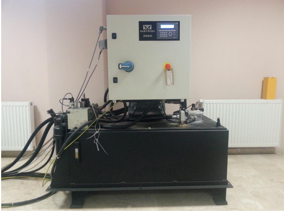
Şekil 5.8a: Hidrolik güç ünitesi
