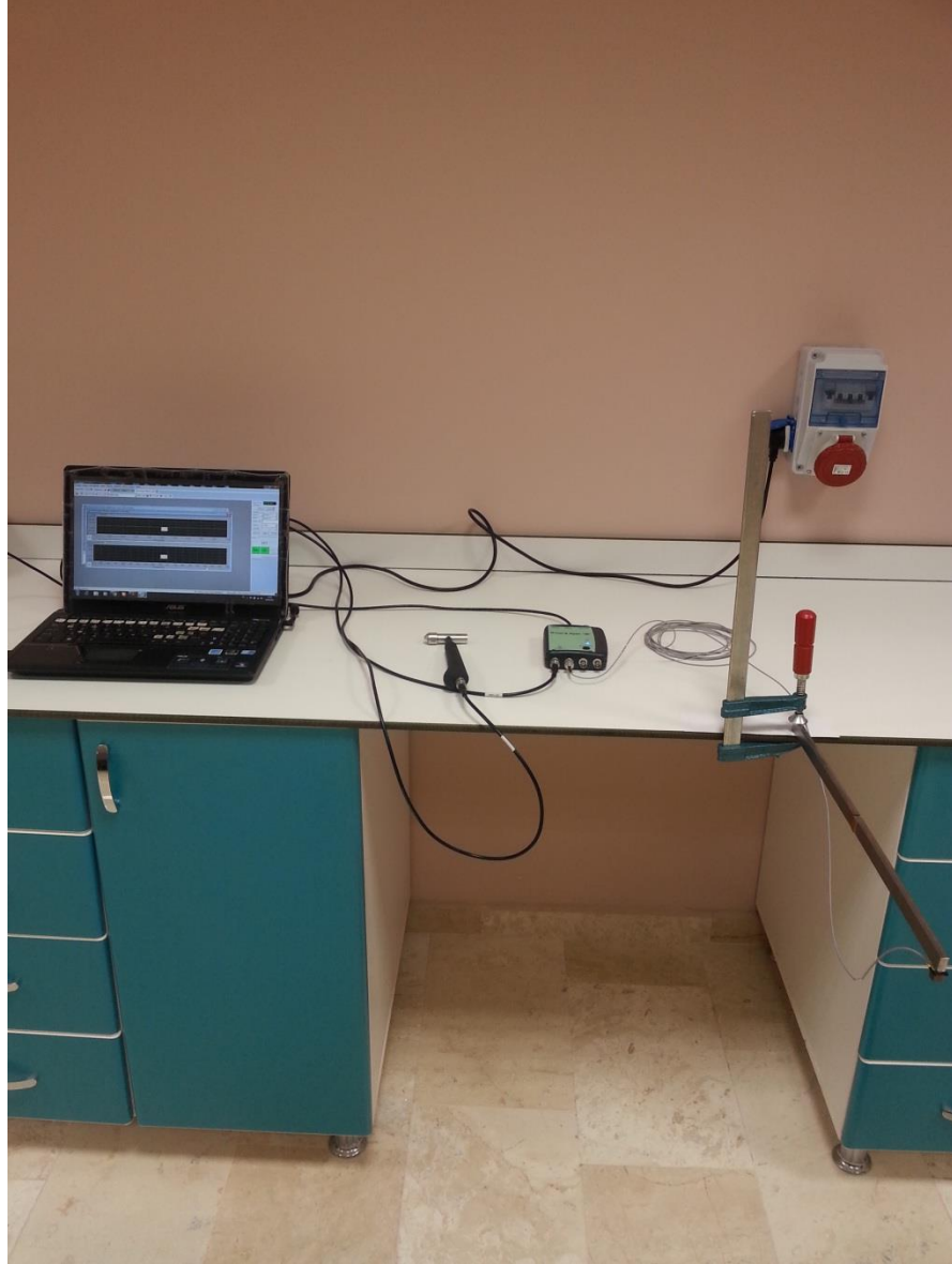
Şekil 5.19: Titreşim verisi toplama seti
