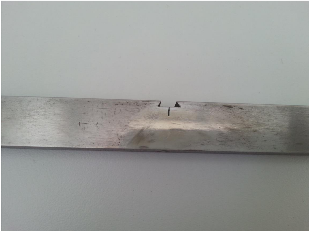
Şekil 5.6: Çatlak yüzeyi parlatılan giriş
