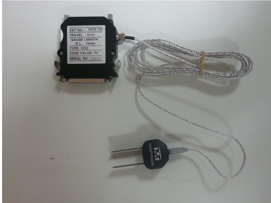
Şekil 5.17: Yorulma çatlak büyümesi testi sırasında kullanılan ekstensometre
