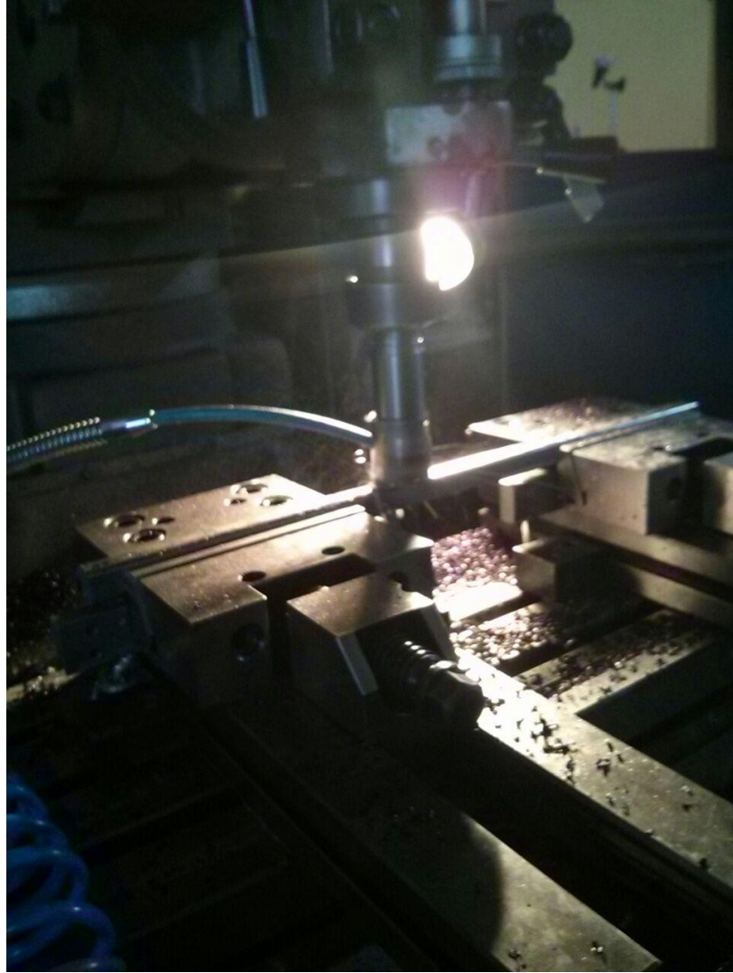
Şekil 5.1: Dairesel kesitli numunelerin freze tezgahında işlenerek kiriş haline getirilmesi
