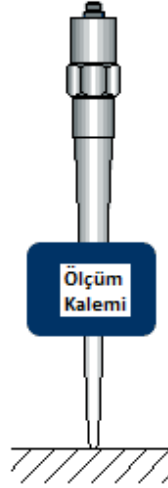
Şekil 3.29: İvmeölçer ucuna ölçüm kalemi takılarak titreşim ölçülmesi
