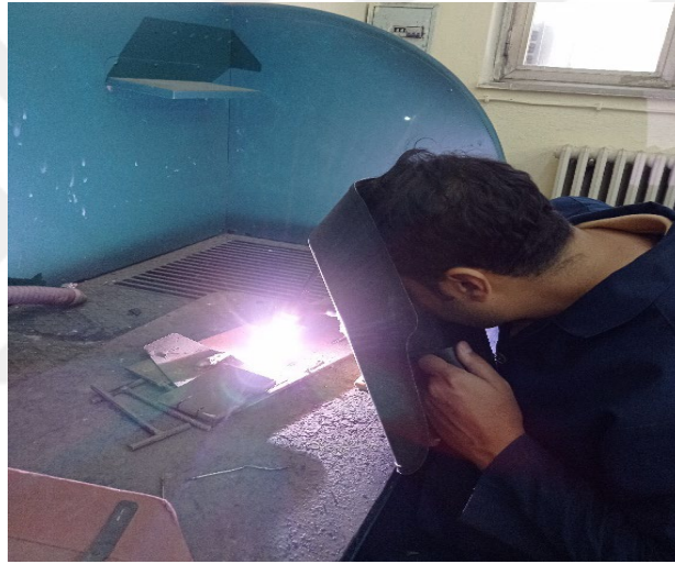
Şekil 4.13. GTA yöntemi kaplama işlemi
