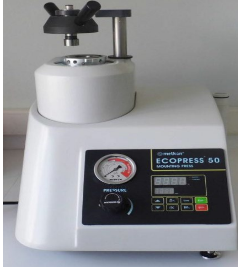
Şekil 4.16. Bakalit cihazı(kalıba alma makinesi)
