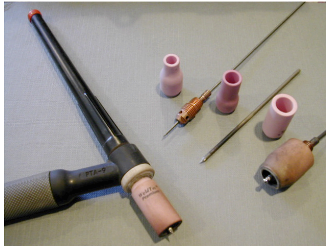
Şekil 3.11. GTA kaynağında kullanılan Torç (Vikipedi, GTA Kaynağı, 2021)
