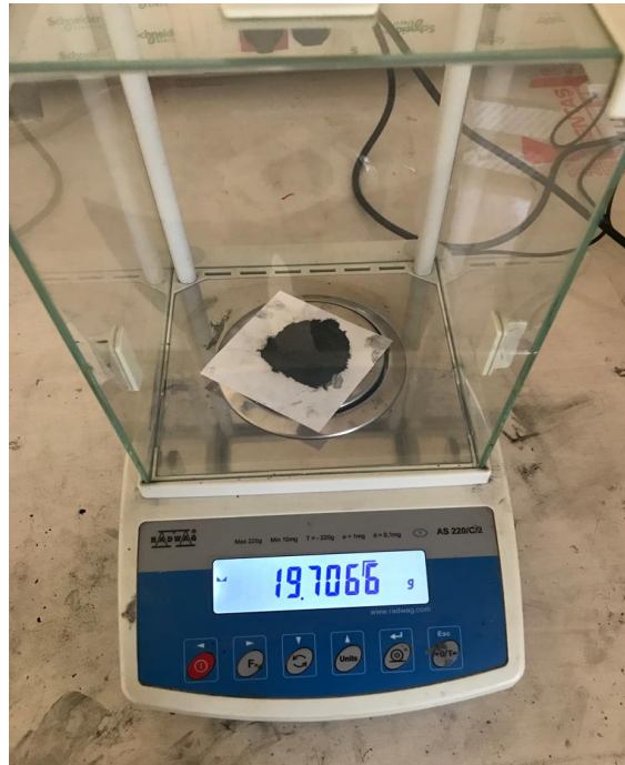
Şekil 4.8. Hassas terazide tozların ölçümü
