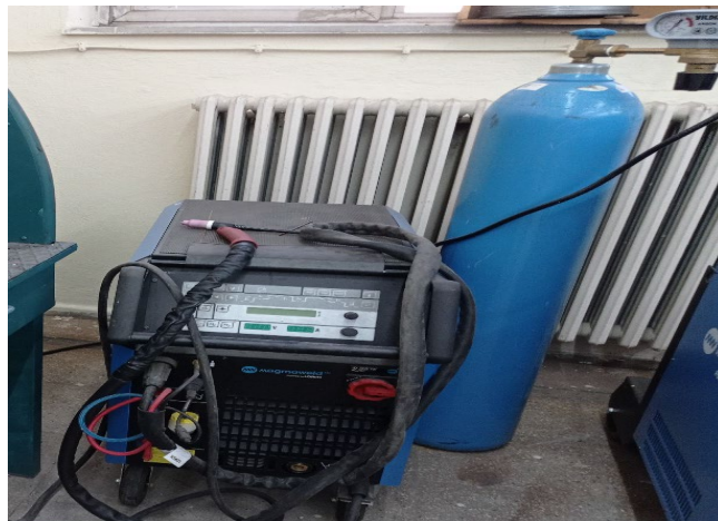
Şekil 4.11. Kullanılan GTA kaynak makinesi
