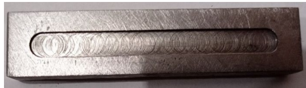
Şekil 4.7. Kaplama yapılacak numune son hali
